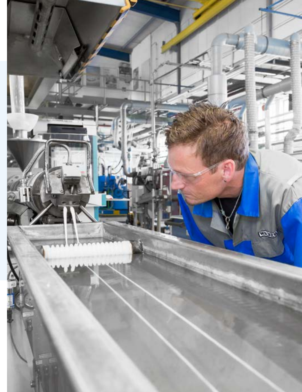
工程师Oliver Fuhrmann正在观察改性料熔体被排入水淬槽的情况。
