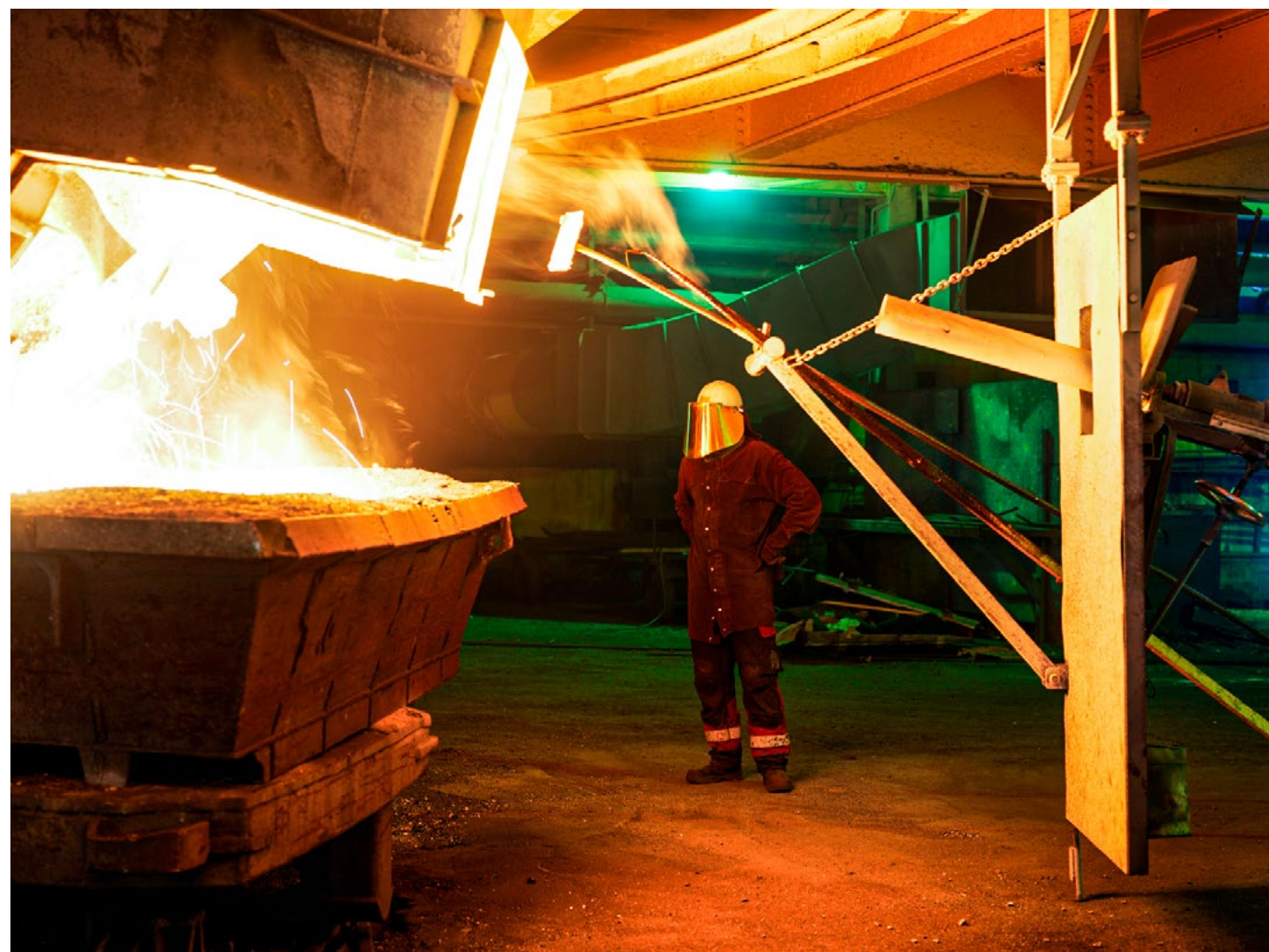
瓦克自 2010 年起在挪威霍拉以石英和硬煤为原料，在 2000 摄氏度的高温条件下生产金属硅。
