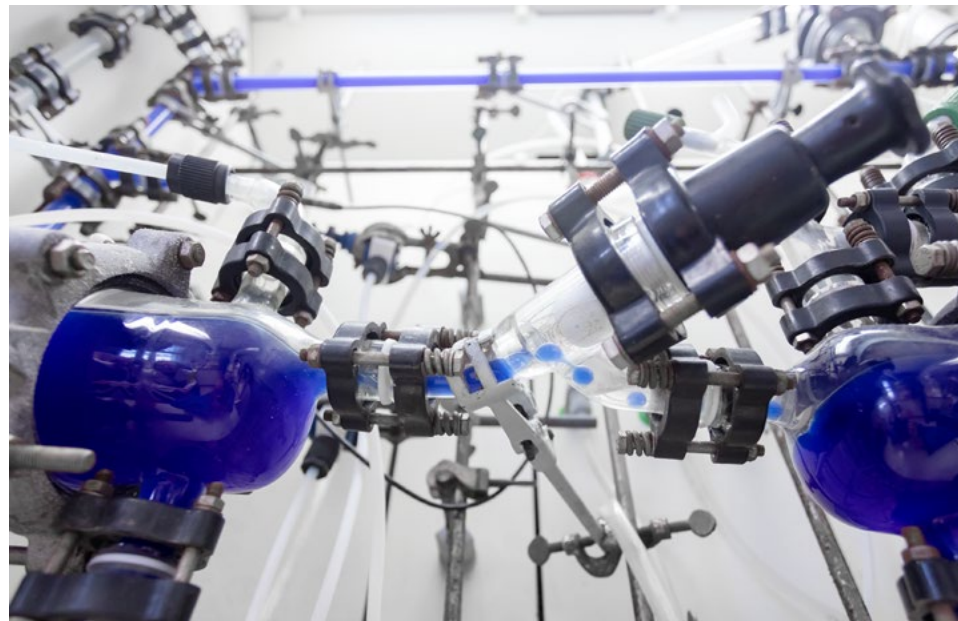
玻璃循环反应器：瓦克博格豪森生产基地应用技术实验室开发出一套不间断式有机硅基料生产工艺。
