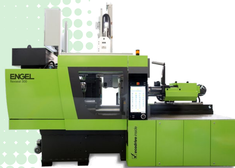
瓦克在 K 展上借助 ENGEL 公司提供的注射成型机，用食品级生物甲醇基硅橡胶生产柠檬榨汁器。
