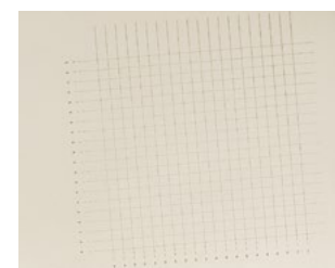
未改性的聚乙烯板的划痕清晰(上图)，添加 GENIOPLAST® PE50S08 的聚乙烯板的划痕硬度大大提高(下图)。
