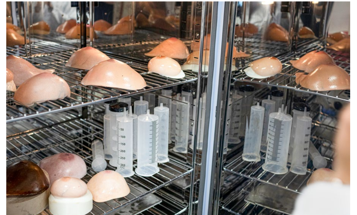
有机硅乳房假体的不同组成部分在干燥箱中固化。
