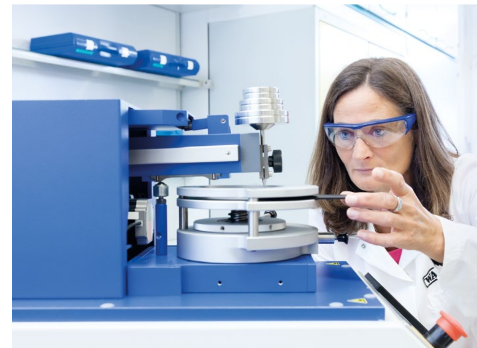
在 ERICHSEN 划痕硬度测试中，针尖用准确设置的压力和速度划过塑料试样的表面，生成划痕网格，之后，检查划痕，并用色度计测定颜色差异。
