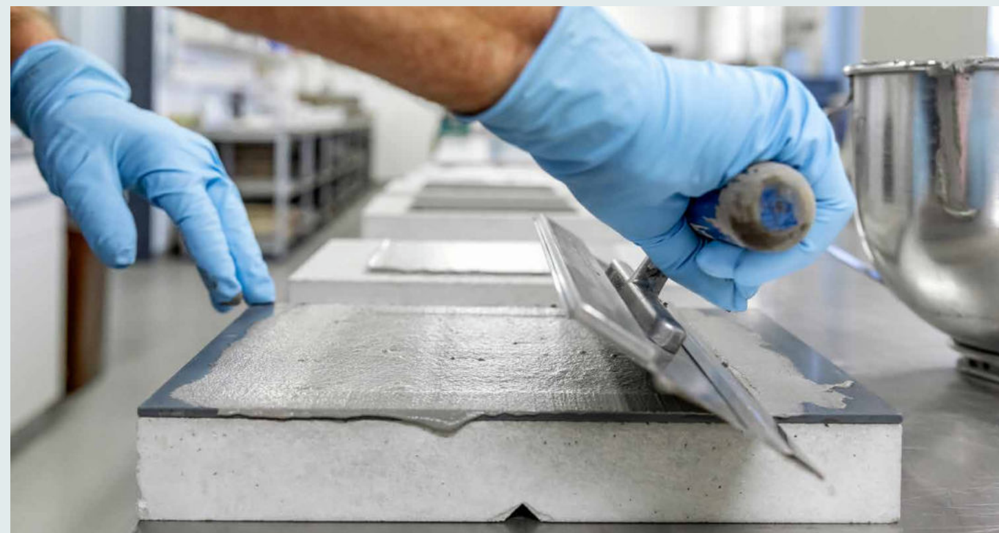
根据 EN -7 标准进行抗裂测试时，将防水砂浆拉伸至规定的厚度。
