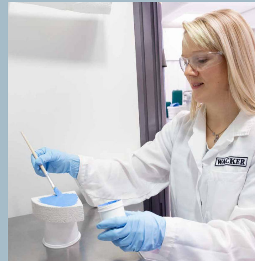
在瓦克应用技术实验室中，VINNAPAS® 威耐实® EP 3560 被涂抹到加气混凝土石块测试样品上。
