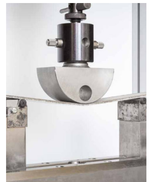
瓦克在应用技术实验室根据 EN 12004-2 标准检测瓷砖胶粘剂的形变情况。
