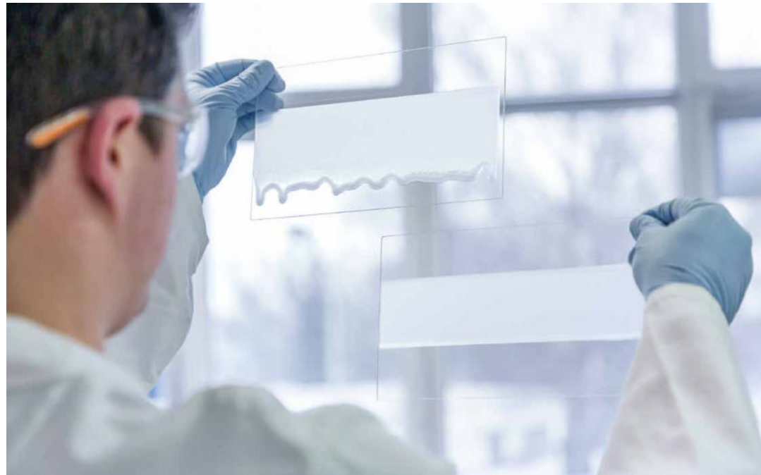
经 HDK® H21 触变处理的环氧树脂被涂覆在倾斜放置的玻璃板上：采用 HDK® 气相二氧化硅制成的极性胶粘剂没有流动，涂层具有抗流挂性。
