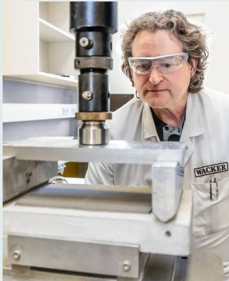
在实验室中，技术员根据 EN 1062-7 标准测试混凝土测试样品的挠度。该标准规定，缝隙的开裂程度不得大于 0.4 毫米。
