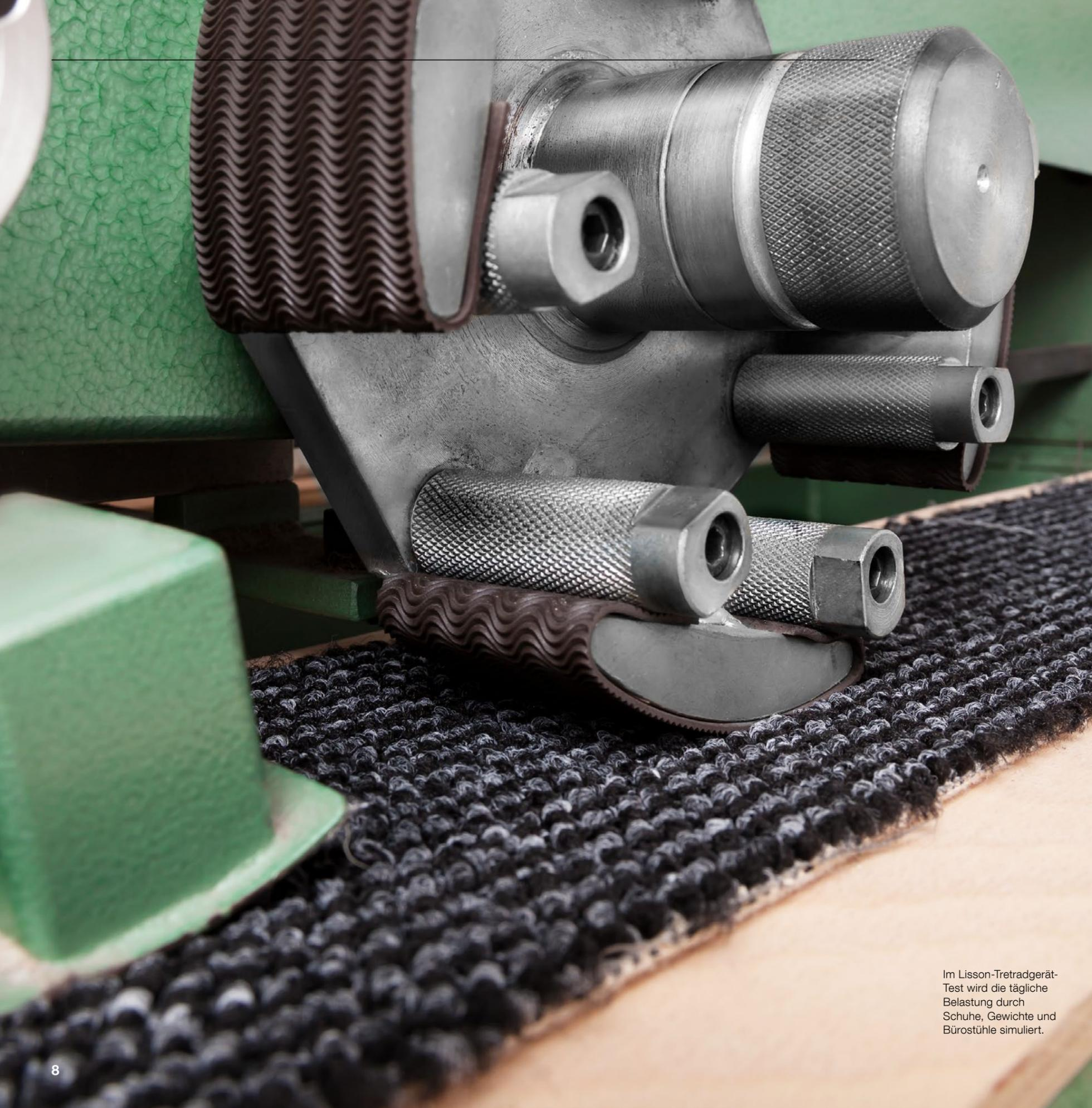
Im Lisson-Tretradgerät-Test wird die tägliche Belastung durch Schuhe, Gewichte und Bürostühle simuliert.
