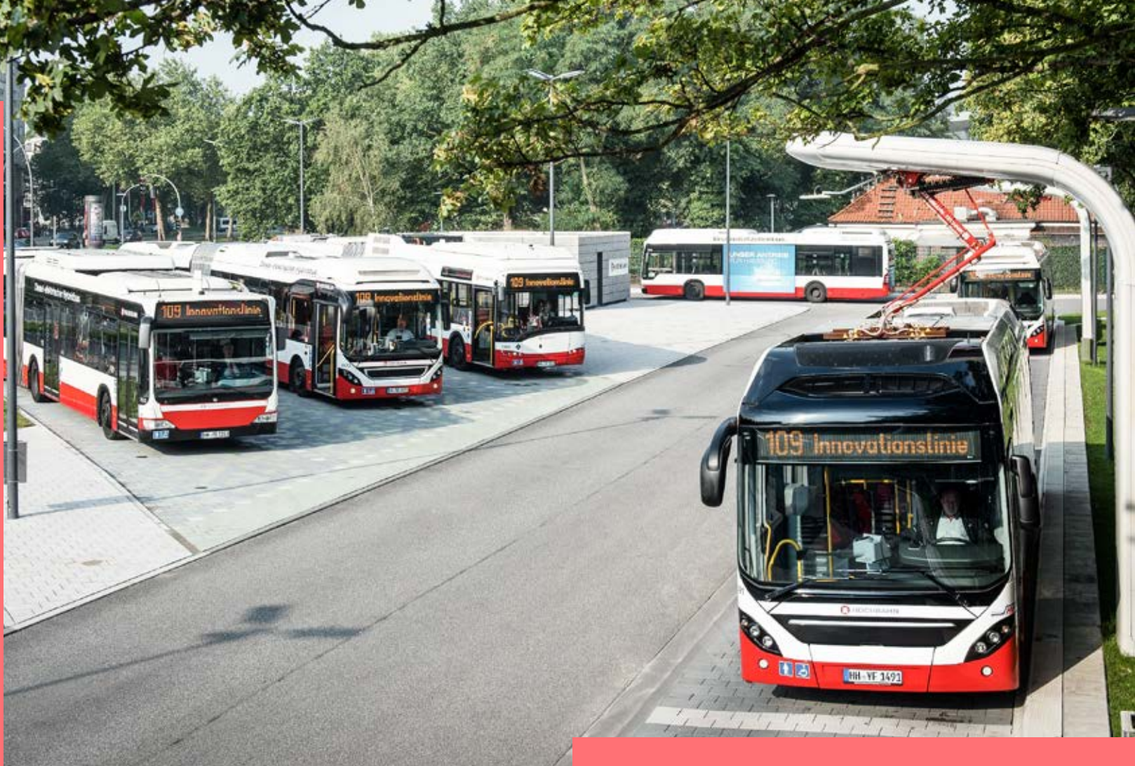
Hamburger Hochbahn 公共交通公司 (HHA) 运营的沃尔沃 (Volvo) 混合动力公共汽车正在充电站充电: HHA 公司希望在近几年内将运营的约 1,000 辆柴油车全部换成电动车。
