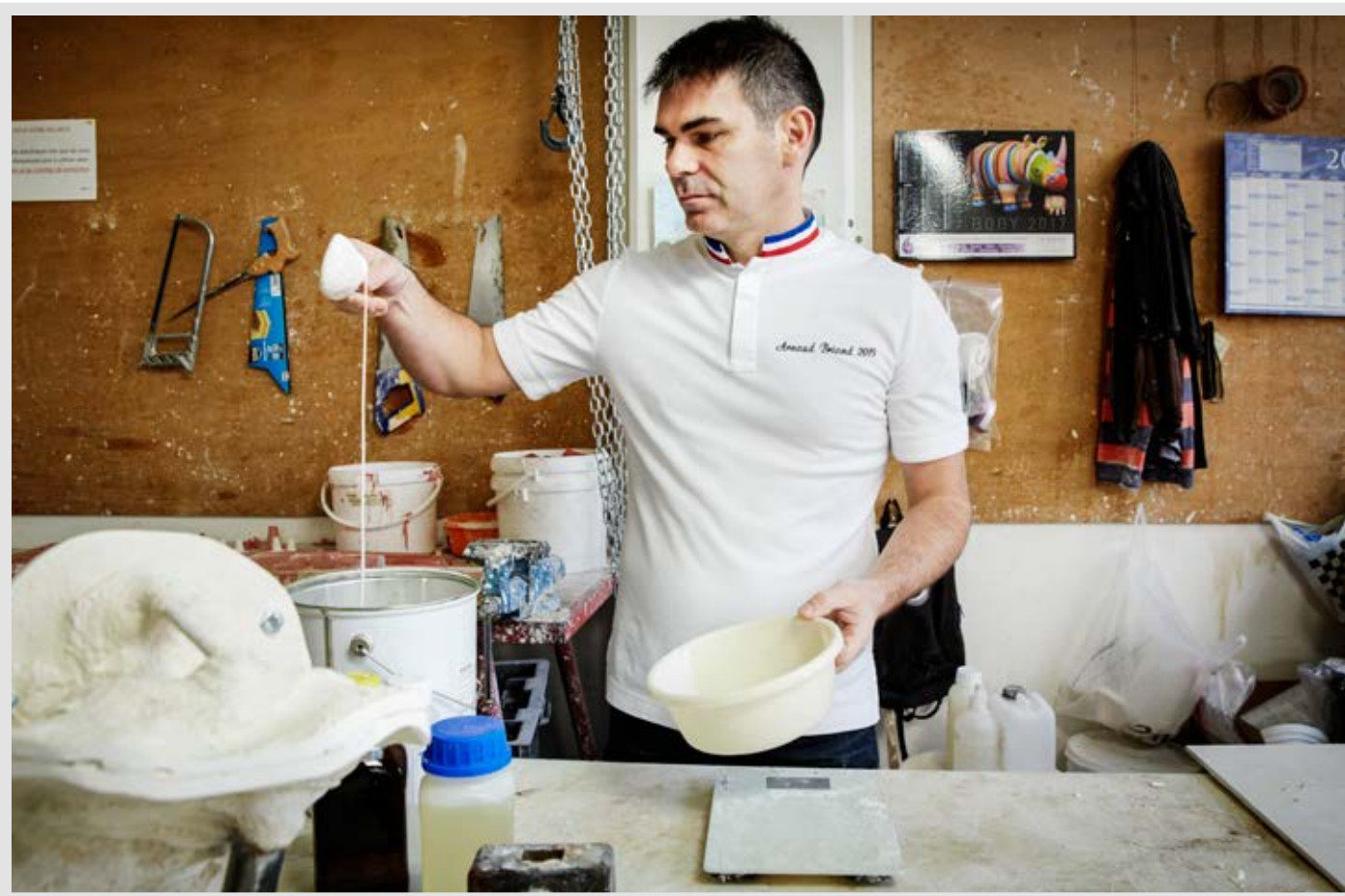
上图： 享有“法国最佳工艺大师”称号的Arnaud Briand正在混合有机硅。他对配方如数家珍，并且能按照当前的室温和湿度对配方进行调整。
