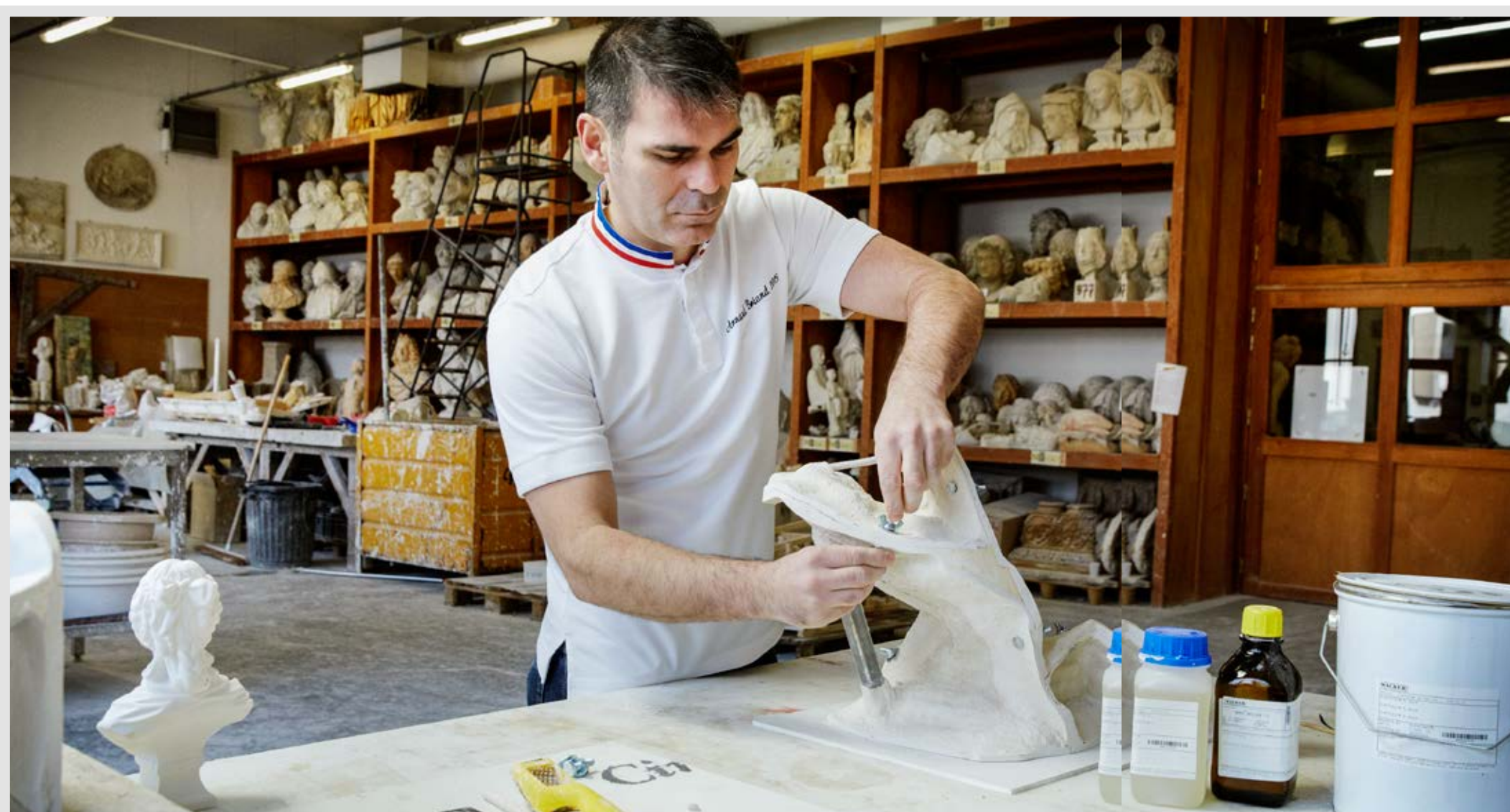
上图：采用铸造工艺制作模具时，在铸造前首先要将各个部件牢固地安装在一起。图中是一款畅销品的小型复制品：萨莫色雷斯的胜利女神（Nike of Samothrace）。
