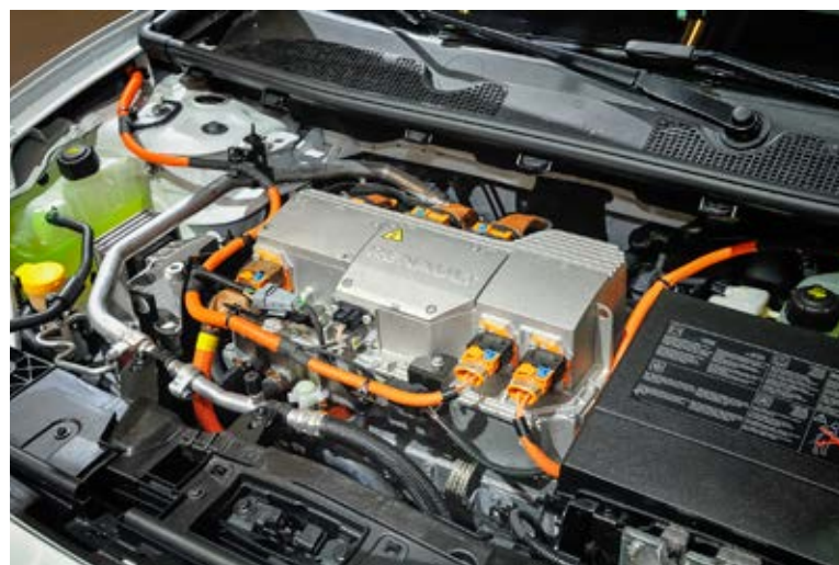
雷诺风朗 (Renault Fluence) 的引擎舱：这款汽车配备的动力电池可在提供特殊服务的充电站进行更换，从而避免了耗时的充电过程。引擎盖下，橙色的粗高压电缆非常醒目。
