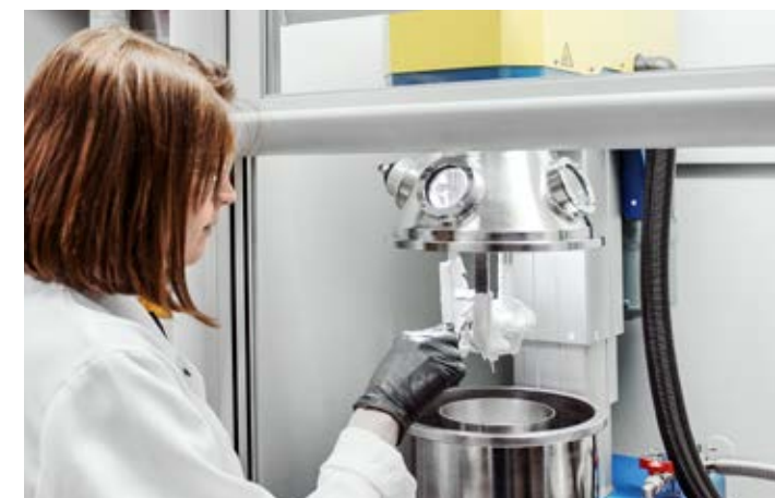
在莫斯科的技术中心，实验室助理 Ekaterina Aleksandrova 正使用行星式混合器混合一款以硅烷改性聚醚为基料制成的低模量密封胶。
