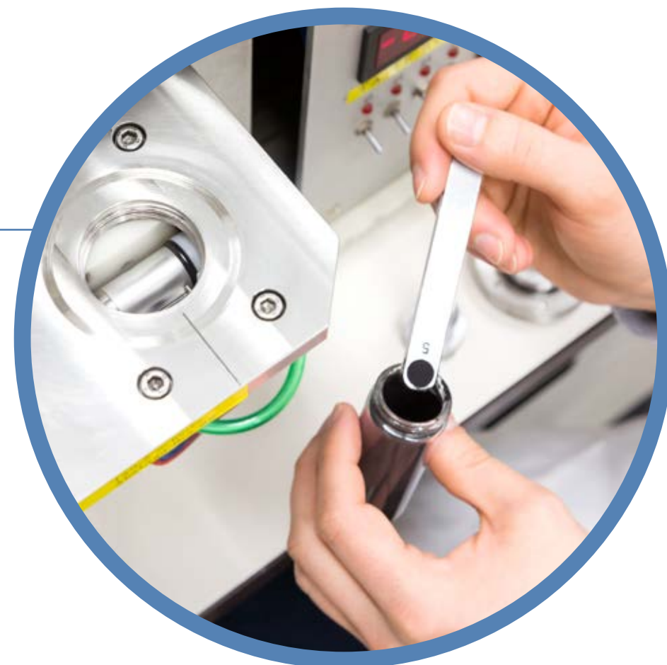
将一定剂量的磁性墨粉送至滚动的辊轴，对其充电并人工老化，以模拟一定数量的影印件；对墨粉的充电量由测量仪表控制。
