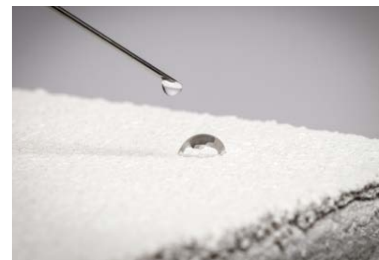
使用经 VINNAPAS® 威耐实® 憎水性可再分散乳胶粉改良的饰层砂浆或填缝砂浆，可大大提高建筑物的耐候性，延长其使用寿命。
