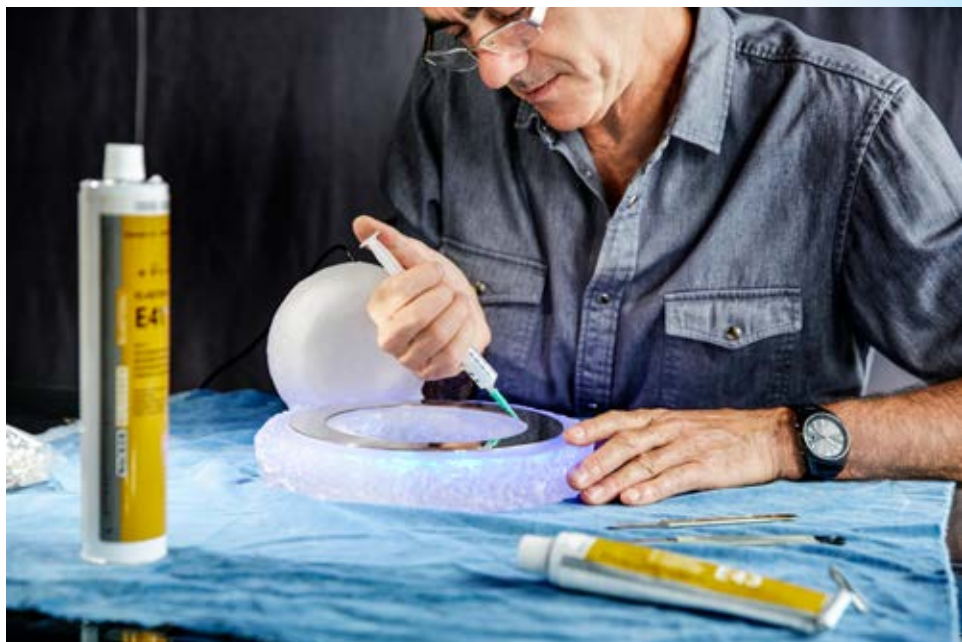
20 多年来，Alain Persouyre 一直在使用瓦克的两款工业用液体胶粘剂：ELASTOSIL® E43 和 E41。这两种产品都是单组分有机硅胶粘剂，能够在室温下固化，使用起来非常方便。
