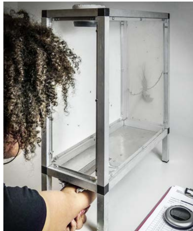
BIOGENTS 公司对驱蚊剂进行人体测试：测试者手臂被蚊子叮咬的次数越少，说明驱蚊剂的效用越强。
