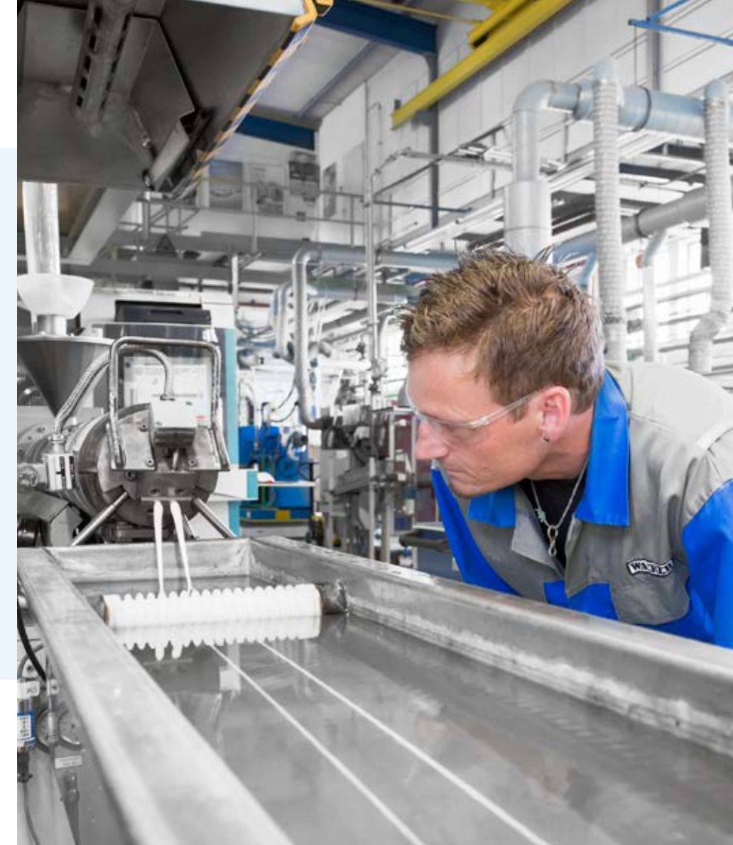
Entwicklungsingenieur Oliver Fuhrmann beobachtet den Schmelzeaustritt des Compounds ins Wasserbad.
