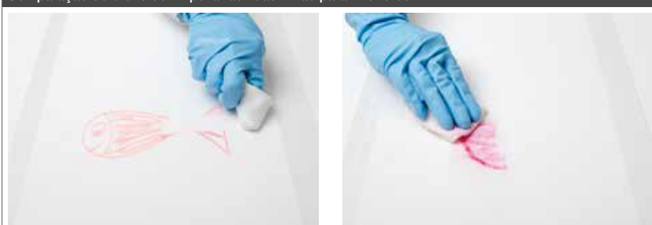
Remoção de marcador de texto. Esquerda: formulação de tintas sem PRIMIS® SAF 9000. Direita: formulação de tintas com PRIMIS® SAF 9000.
