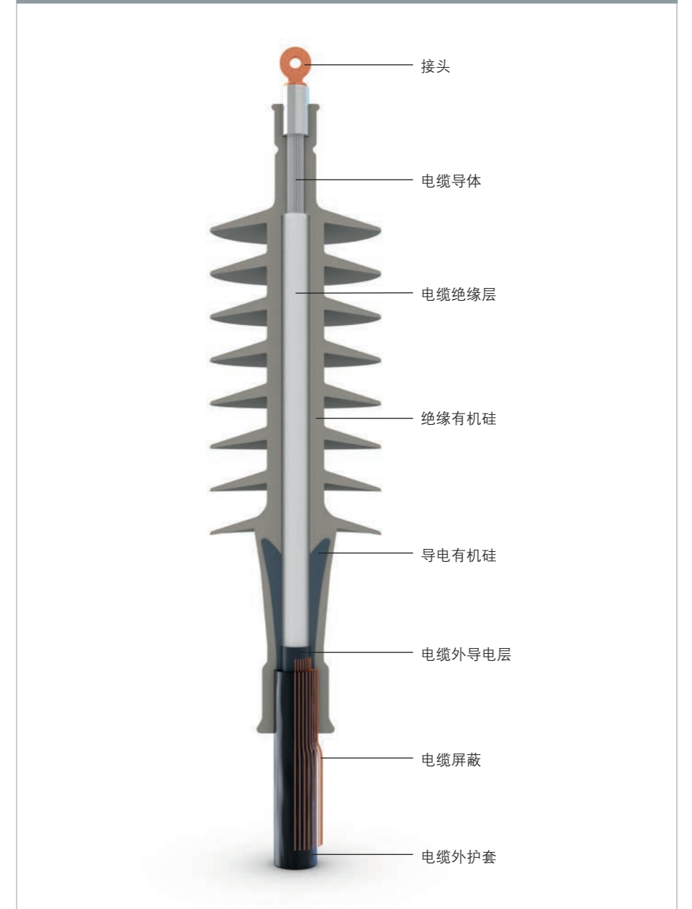
电缆终端的设计原理
