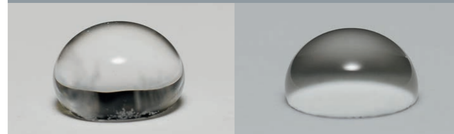
污秽有机硅涂层上的水滴
