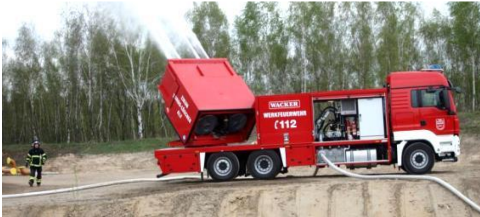
Aerosollöschfahrzeug mit einer Reichweite von bis zu 140 m feinst verteilter Wassertröpfchen zum Niederschlagen von Gaswolken bei Ereignissen.
