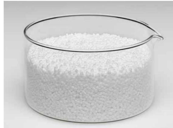
Siliconadditive – hier gebrauchsfertige Pellets – erleichtern die Herstellung verarbeitungsfähiger Polyethylen-Formmassen und verbessern die Oberflächeneigenschaften der daraus hergestellten Kunststoffartikel.
