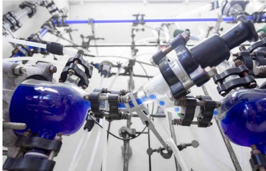
Gläserner Umlaufreaktor: WACKER hat in einem seiner anwendungstechnischen Labors am Produktionsstandort Burghausen einen kontinuierlichen Fertigungsprozess für Harzbindemittel entwickelt.
