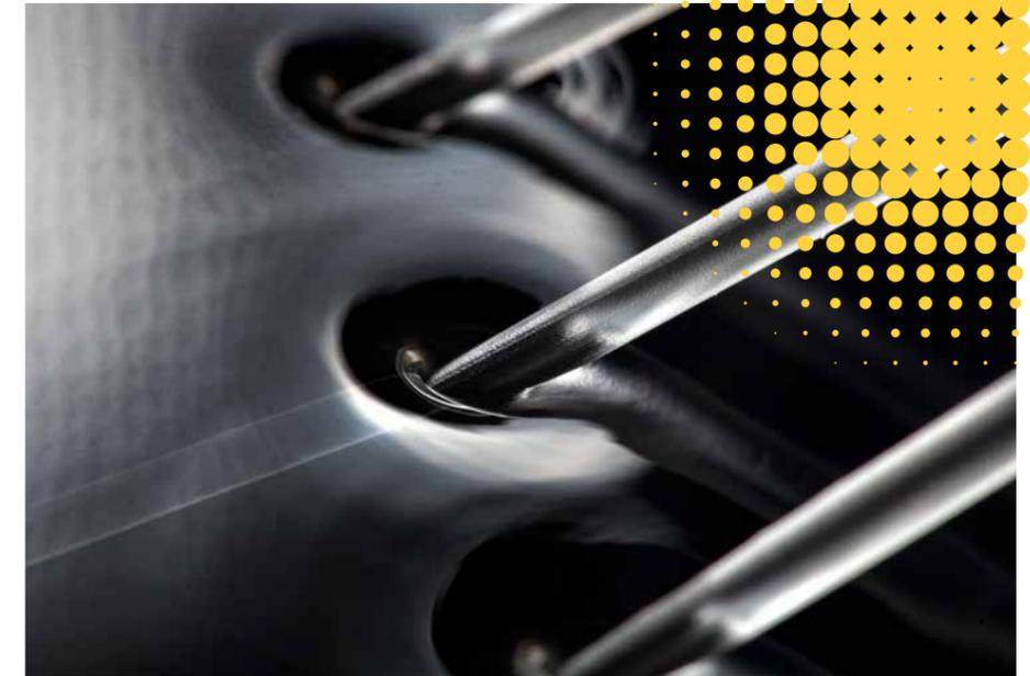
Vorstufe für die Herstellung von Blas- oder Flachfolien: Aus einem Biokunststoff und VINNEX® 2526 wird ein transparentes Granulat hergestellt. Extrusionsstränge tauchen dazu in ein Wasserbad.
