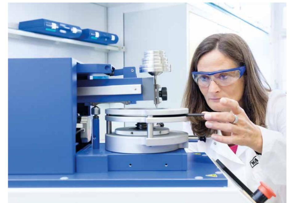
Beim Erichsen-Kratztest fährt eine Nadel mit einer genau eingestellten Kraft und Geschwindigkeit über die zu prüfende Kunststoffoberfläche und erzeugt ein Kreuzgittermuster aus Kratzspuren. Die Kratzspuren werden anschließend näher untersucht und die Farbunterschiede mithilfe eines Farbmessgerätes bestimmt.
