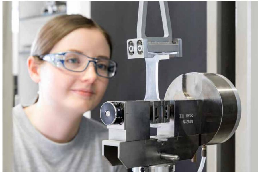
In den Schälversuchen werden Verbundprüfkörper bis zum Bruch belastet. Bei den Verbundprüfkörpern aus ELASTOSIL® LR 3078 und Polycarbonat riss stets die Silicon-Weichkomponente; die Verbindung von Hart- und Weichkomponente blieb dagegen in allen Fällen erhalten.
