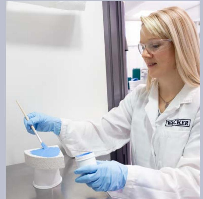
Auf einen Prüfkörper aus Porenbetonstein wird im anwendungstechnischen Labor von WACKER Farbe mit VINNAPAS® EP 3560 aufgetragen.
