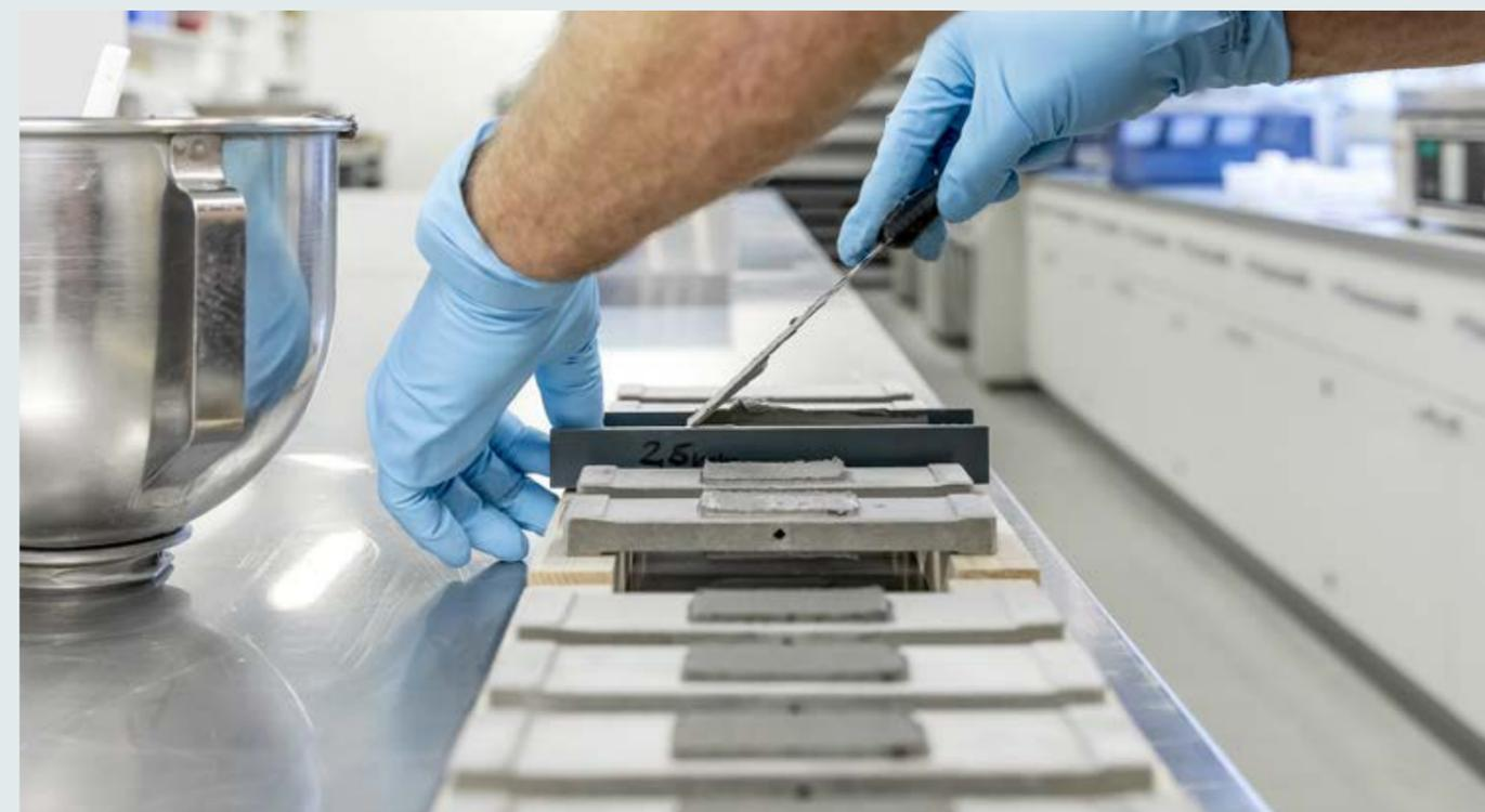
Probenpräparation für die Rissüberbrückungsprüfung nach EN 14891.
