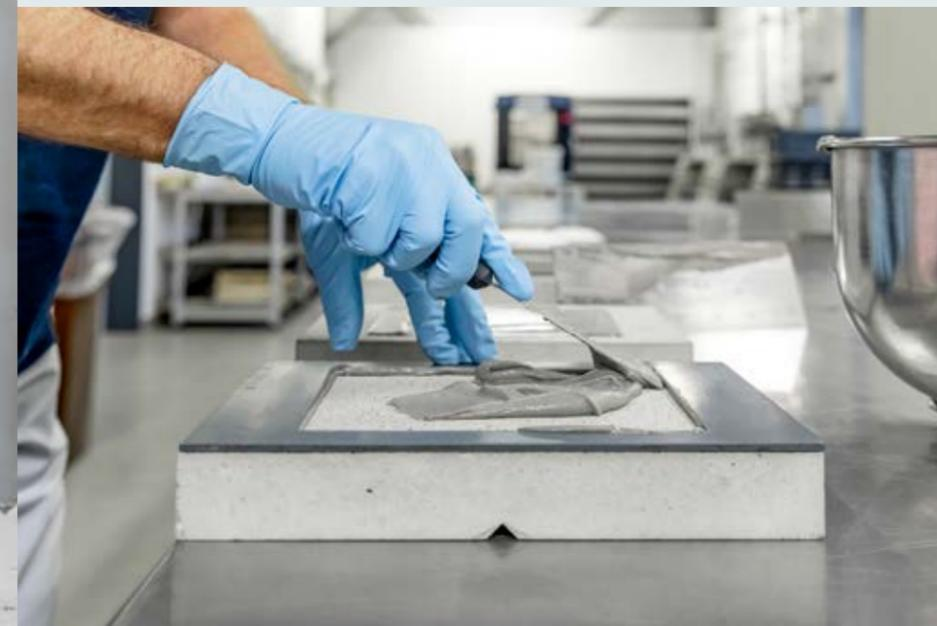
Die Dichtungsschlämme wird auf einen Prüfkörper aus Beton nach EN 1062-7 aufgetragen.
