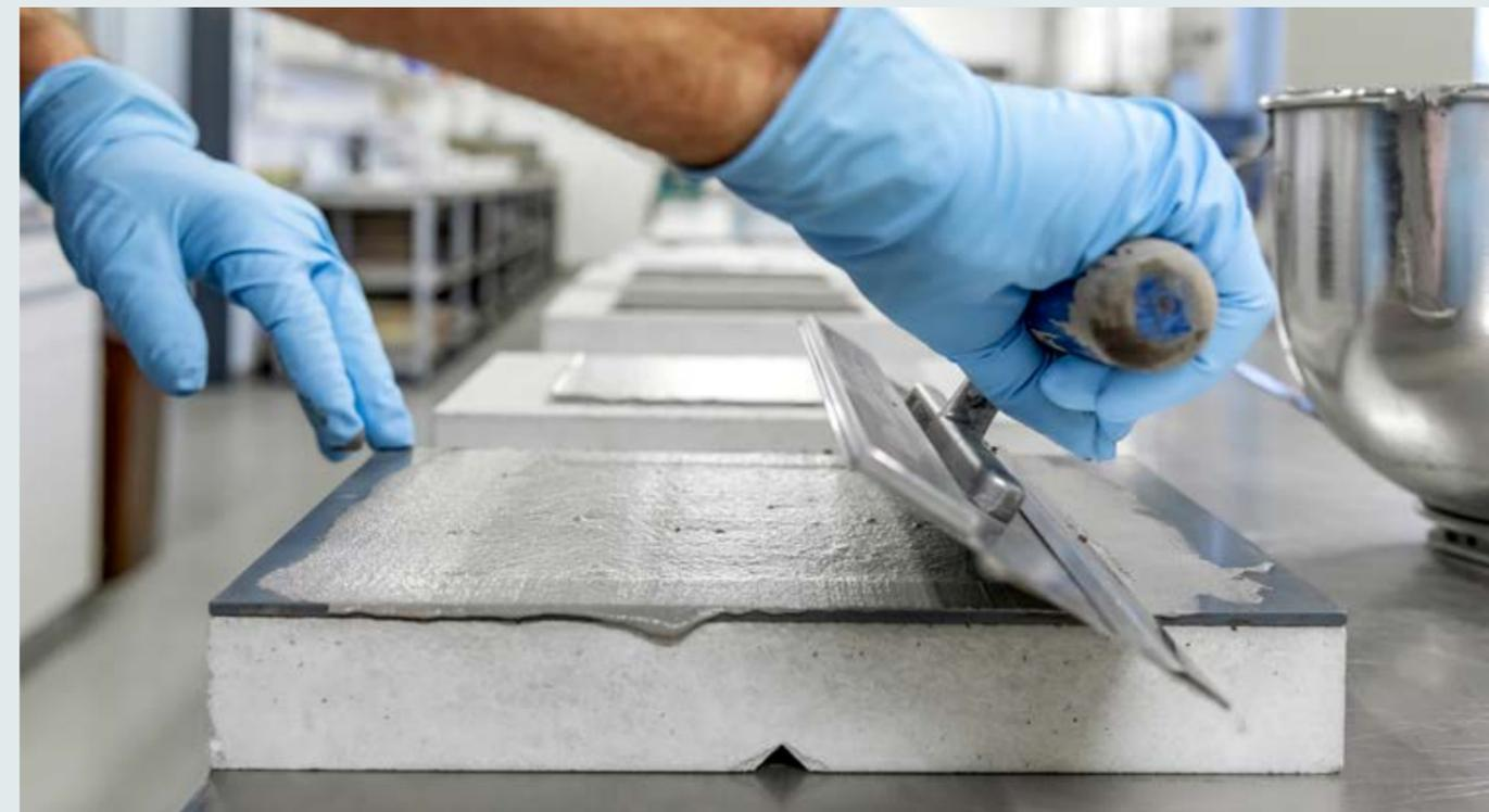
Für die Rissüberbrückungsprüfung nach EN 1062-7 wird die Dichtungsschlämme auf eine definierte Schichtstärke abgezogen.
