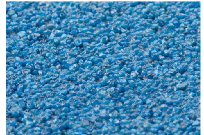
Das neue silanbasierte Bindemittel SILRES® BS 6921 eignet sich dank seiner Haftfähigkeit und Elastizität zur Formulierung von flexiblen fleckresistenten Anti-Schmutz-Beschichtungen für Beton-, Epoxid- und Polyurethanböden sowie zur Herstellung von Steinteppichen und drainagefähigen Systemen.
