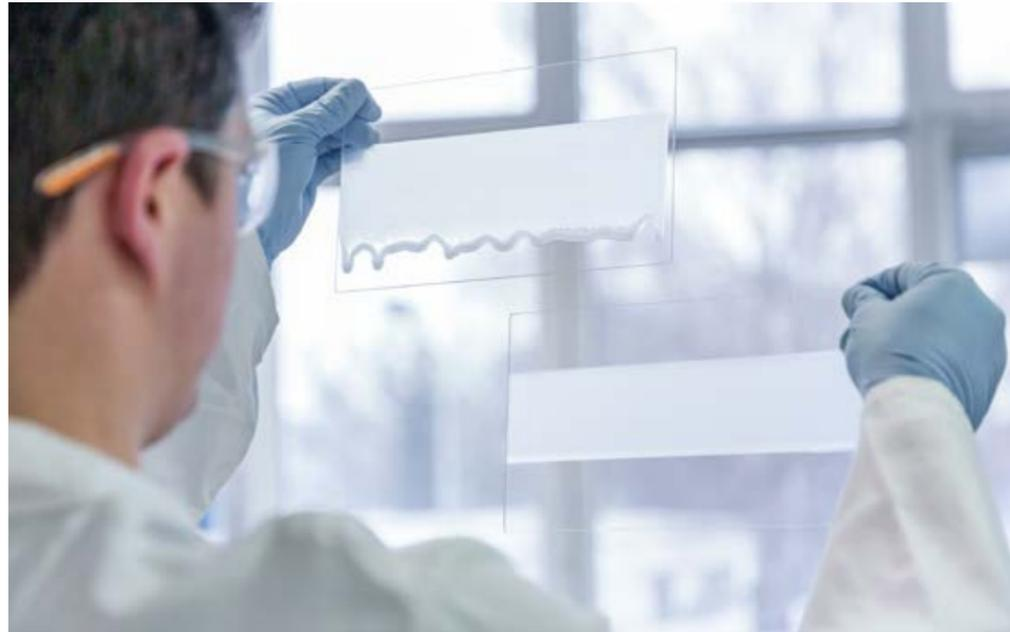
Ein mit HDK® H21 thixotropiertes Epoxidharz wird auf einer geeigneten, schräg stehenden Glasplatte aufgetragen: Die polare Klebstoff-Komponente mit HDK® fließt nicht ab, die Schicht ist standfest.
