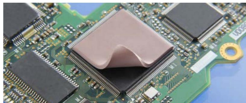
SARCON® Thermal Gap Filler Pads von Fuji Polymer Industries sind extrem passgenaue, wärmeleitfähige Gele in Mattenform. Sie haften auf Komponenten beliebiger Größe und Form, auch wenn diese Unebenheiten oder Vertiefungen aufweisen.
