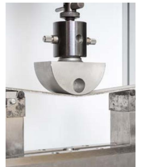
In den anwendungstechnischen Laboren von WACKER wird die Verformbarkeit der Fliesenkleber nach EN 12004-2 getestet.
