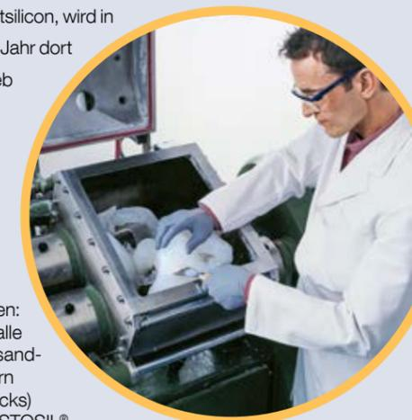
Bild oben: Lagerhalle mit Versandbehältern (Hobbocks) für ELASTOSIL®-Flüssigsiliconkautschuke. Bild rechts: Mischanlage zur Verarbeitung von Siliconkautschuk.
