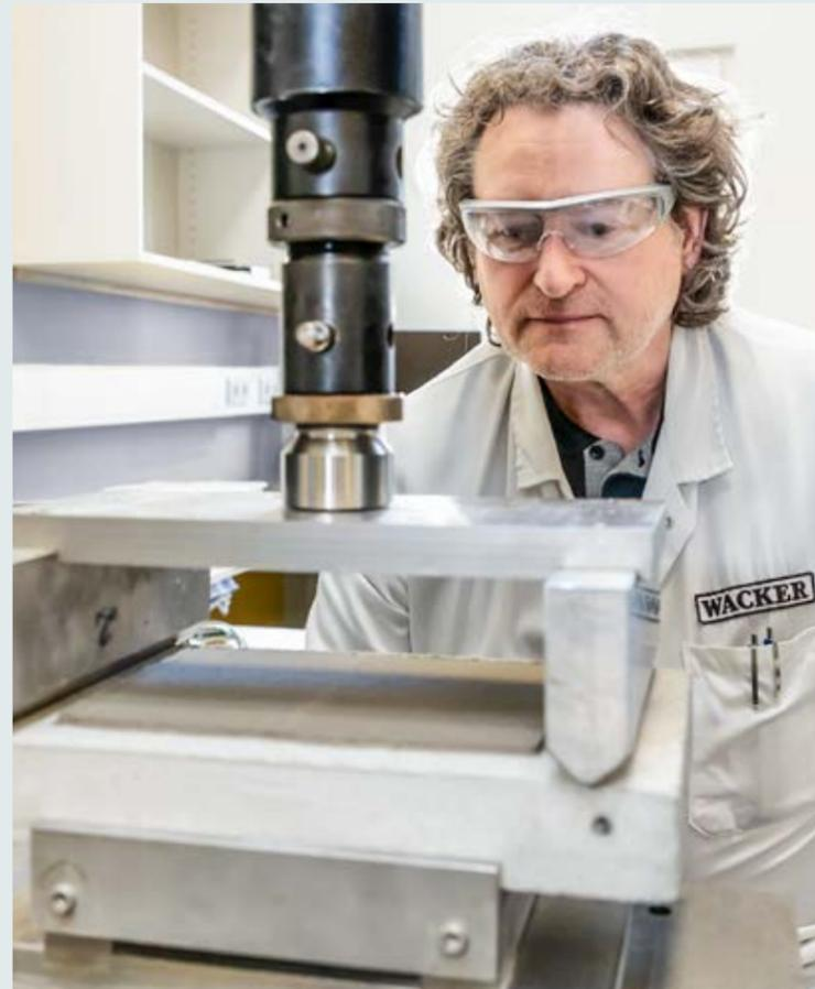
Im Labor testet ein Techniker die Durchbiegung des Betonprüfkörpers nach EN 1062-7. Die Norm erlaubt eine Rissaufweitung nur bis zu 0,4 Millimeter.
