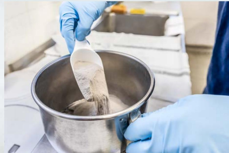
Im anwendungstechnischen Labor von WACKER wird der polymer-modifizierte Trockenmörtel mit Wasser redispersiert.
