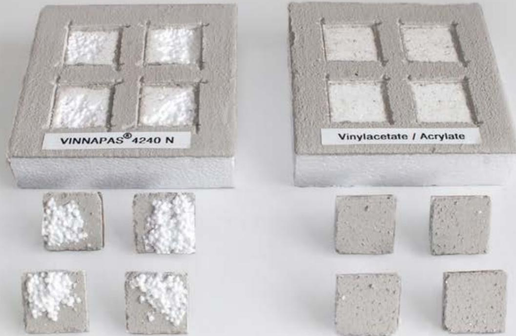
Laborversuche zeigen, dass VINNAPAS® 4240 N (l.) bereits nach einem Tag eine bessere Haftzug- sowie Ausreißfestigkeit als herkömmliche Marktprodukte (r.) aufweist. Dadurch kann ein sehr hoher Haftverbund zwischen EPS-Platte und Mauerwerk in Wärmedämmverbundsystemen sichergestellt werden.
