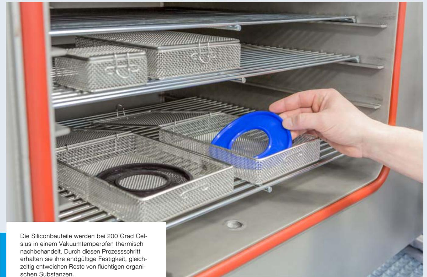
Die Siliconbauteile werden bei 200 Grad Celsius in einem Vakuumtemperofen thermisch nachbehandelt. Durch diesen Prozessschritt erhalten sie ihre endgültige Festigkeit, gleichzeitig entweichen Reste von flüchtigen organischen Substanzen.
