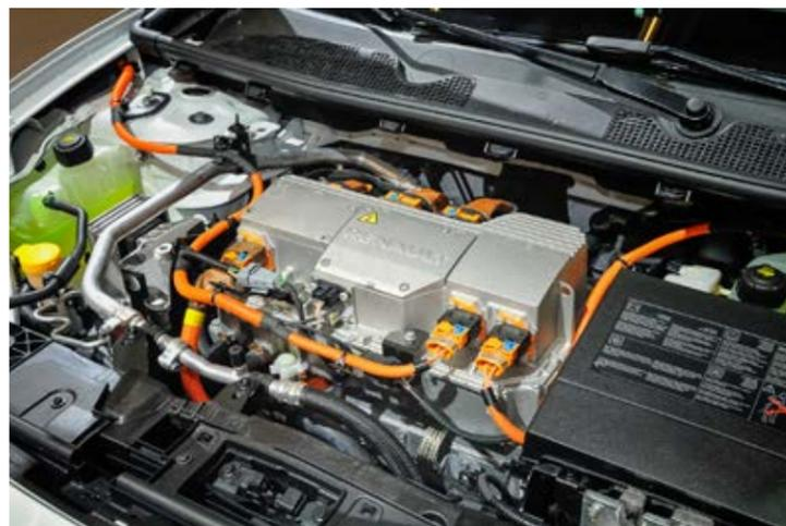
Blick in den Motorraum eines Renault Fluence: Dieses Fahrzeug war mit einer Traktionsbatterie erhältlich, die an speziellen Stationen getauscht werden konnte. Der zeitraubende Ladevorgang entfiel somit. Unter der Motorhaube fallen die dicken orangefarbenen Hochvoltkabel auf.
