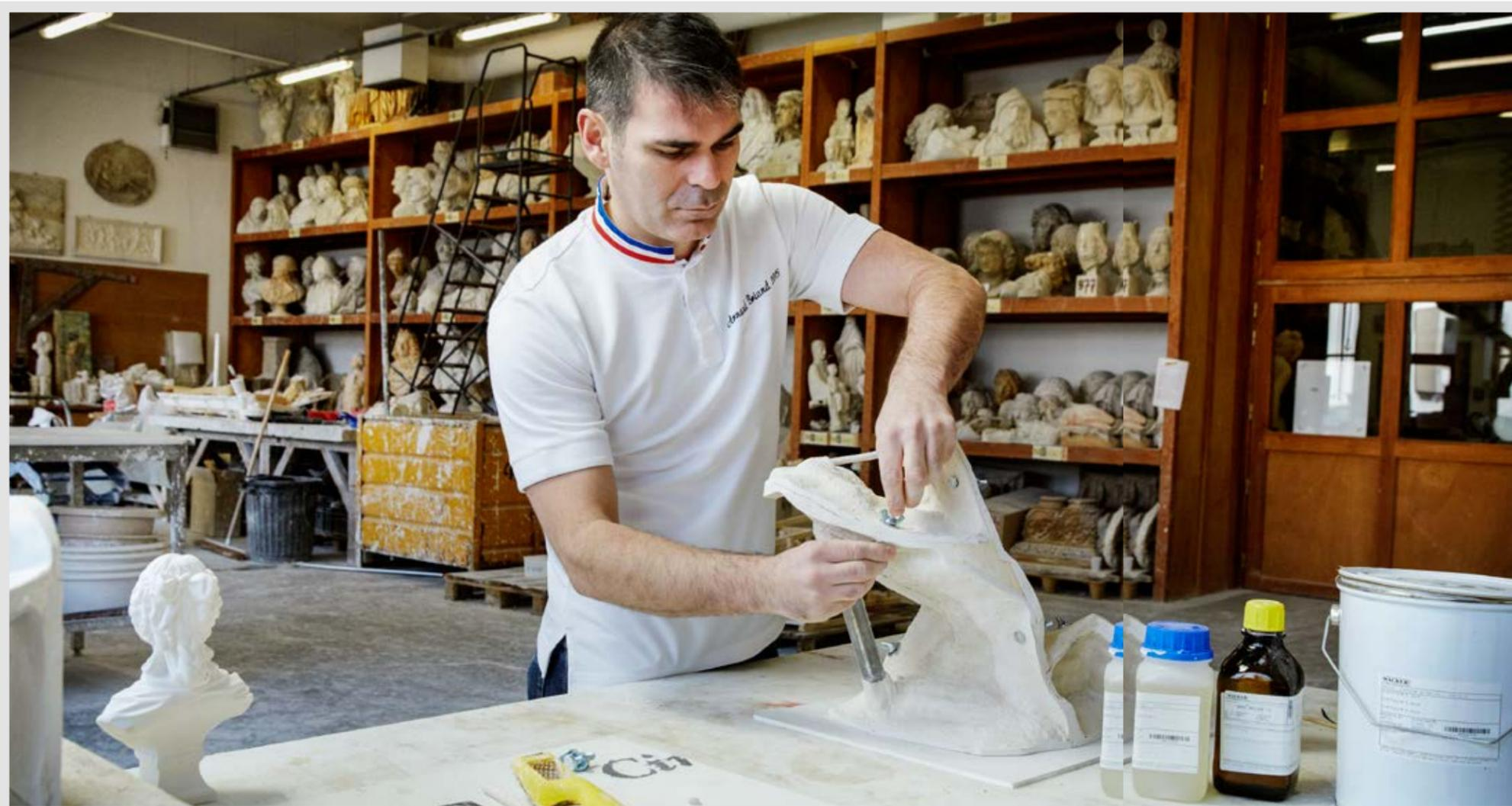
**Oben** Beim Abdruck im Gießverfahren werden vorab die erstellten Einzelteile fest miteinander verschraubt, bevor gegossen werden kann. Hier eine kleinformatige Kopie eines der Bestseller, der Nike von Samothrake.
