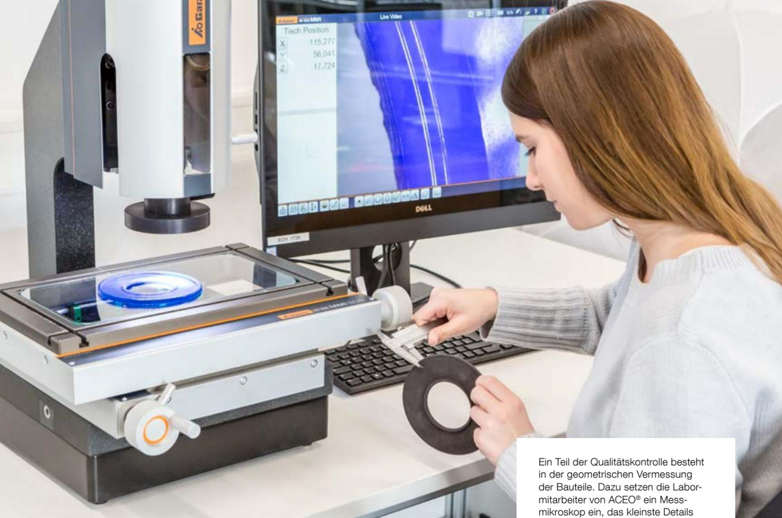
Ein Teil der Qualitätskontrolle besteht in der geometrischen Vermessung der Bauteile. Dazu setzen die Labormitarbeiter von ACEO® ein Messmikroskop ein, das kleinste Details erkennen lässt.
