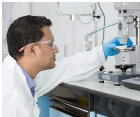
Das WACKER-Labor für Siliconelastomere in Dubai: Ein Mitarbeiter führt eine Shore-Härteprüfung durch.
