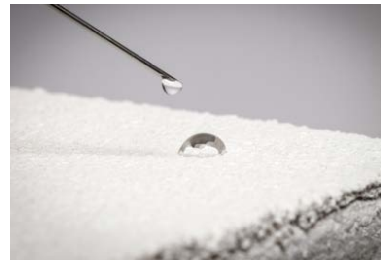
Ober- oder Glättungsputze, die mit wasserabweisenden VINNAPAS® Dispersionspulvern vergütet sind, sorgen für eine verbesserte Witterungsbeständigkeit und damit Langlebigkeit von Gebäuden.
