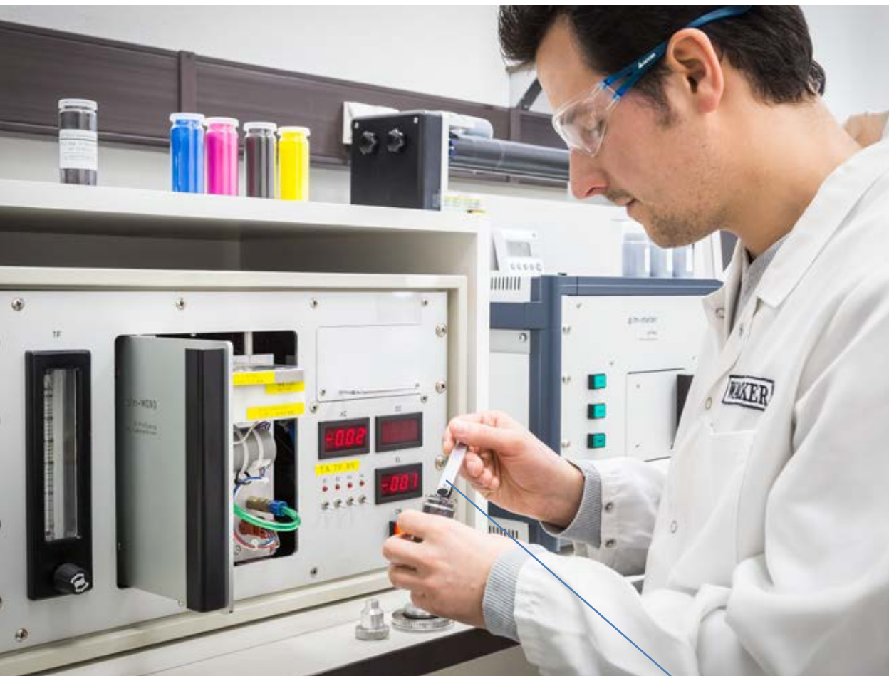
Untersuchung der Aufladbarkeit und Fließfähigkeit eines Tonerpulvers im Labor.
