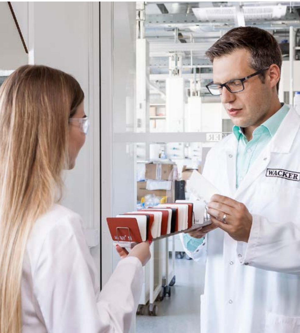
Dr. Christian Anger, Leiter eines anwendungstechnischen Labors für Siliconkautschuke, bei WACKER in Burghausen, wählt aus einer Reihe von Prüfkörpern aus, die auf ihre Hitzebeständigkeit getestet werden sollen.
