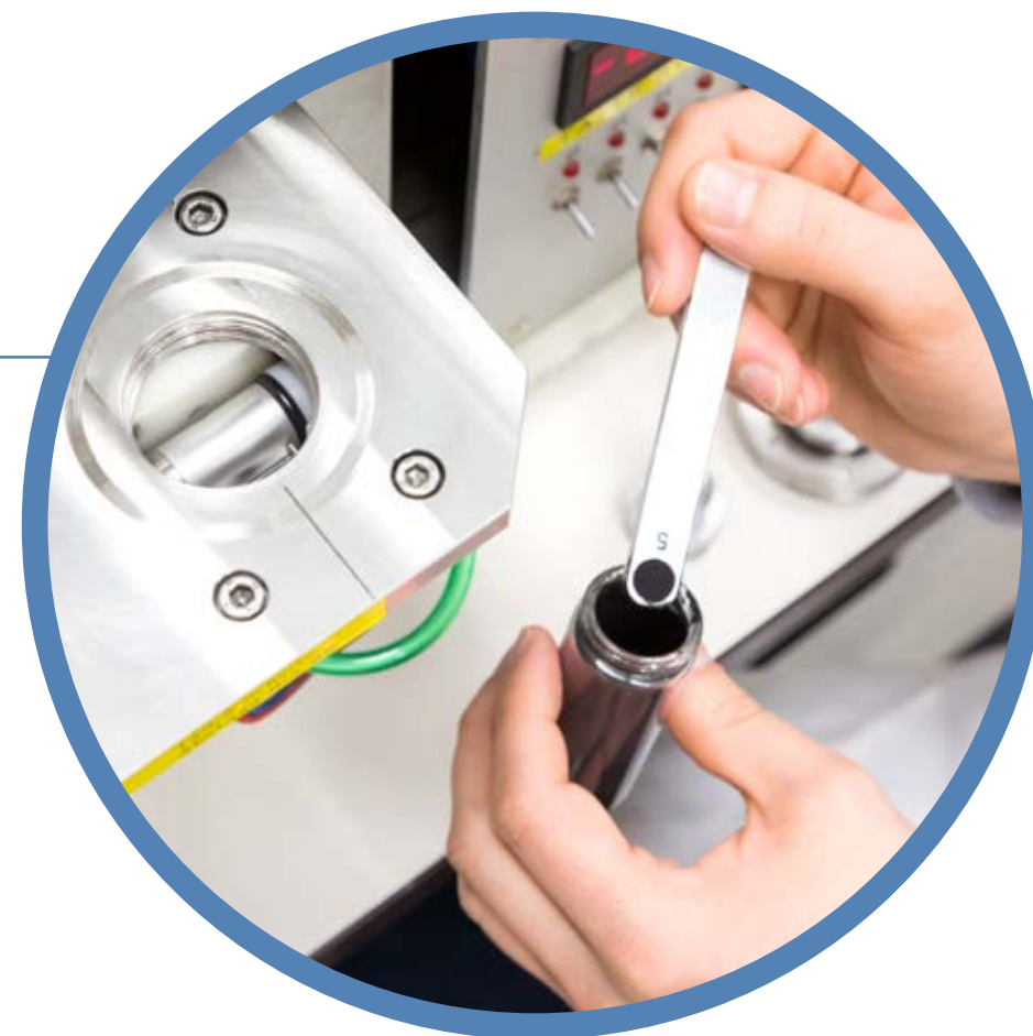
Magnetisches Tonerpulver wird auf eine rotierende Walze dosiert, aufgeladen und künstlich gealtert, um eine bestimmte Anzahl von Kopien zu simulieren. Das Messgerät bestimmt die auf den Toner übertragene Ladung.
