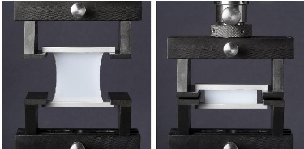
瓦克将在 ASE China 2025 期间展示两款基于  $\alpha^3$  技术的硅烷改性聚合物新品：GENIOSIL®杰粘德® STP-E140 和 STP-E340。实验室测试表明，基于这两款粘结剂的密封胶具有出色的回弹性能。这两款产品可应用于高性能多功能胶粘剂以及高回弹性胶粘剂。 (照片：瓦克)
