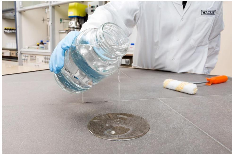
瓦克的硅烷改性聚合物可用来生产液态类防水产品等。此类产品弹性强，并具有抗撕裂性，可保护基材免受潮气和霜冻的损害。（照片：瓦克）
