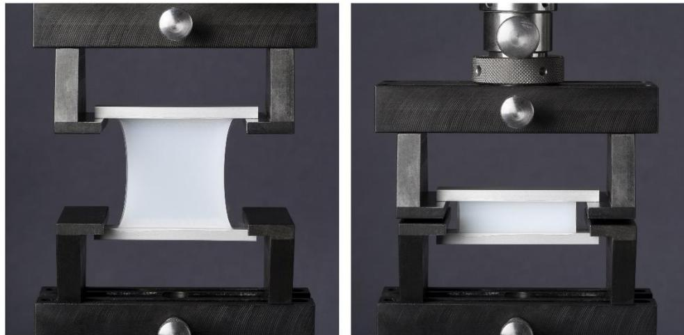
实验室测试表明，基于 GENIOSIL® STP-E 340 粘结剂的密封胶具有出色的回弹性能：瓦克 2025 年 3 月在欧洲涂料展（ECS）上首次展示该产品。
