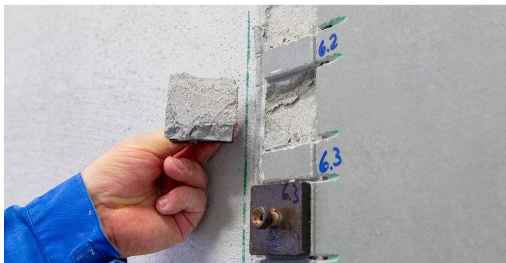
用含 CEM II 水泥，以及在三元共聚物中聚入憎水单体的 VINNAPAS®威耐实® 8118 E、8620 E 或 7220 配制瓷砖胶粘剂，可显著提高其浸水后的拉伸粘结强度，满足相应标准的要求。 （照片：瓦克）
