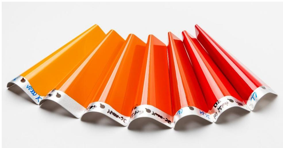
完成锥形弯曲测试后的金属板：SILRES® HP 2000 LV 的延展性出色，涂色后的环氧聚硅氧烷面漆未出现裂缝；瓦克将在 2025 年欧洲涂料展（ECS）上首次展示该固化剂。（照片：瓦克）
