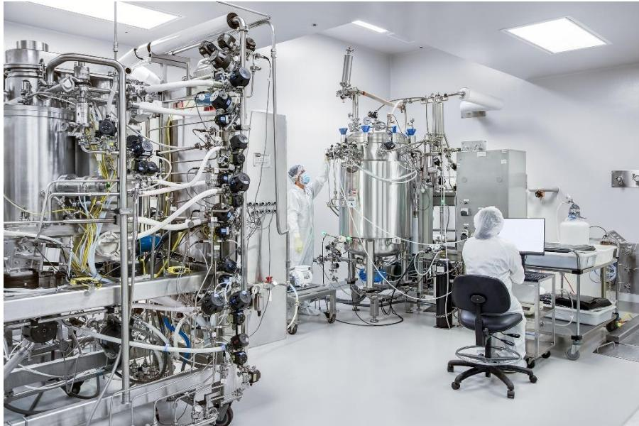
瓦克在圣地亚哥拥有多条产能达 650 升的专业的 pDNA 生产及纯化用发酵生产线，评估工作成功完成后，预期将在这里进行无抗生素 pDNA 的 CDMO 生产。（来源：瓦克化学股份有限公司）
