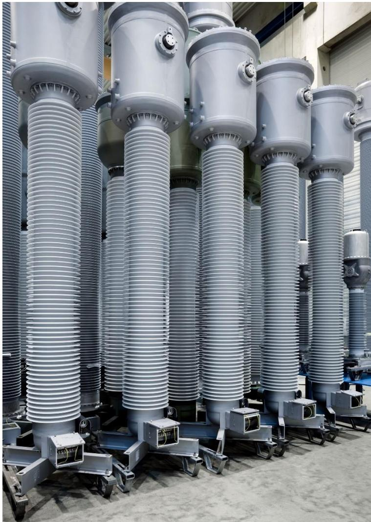
高电压技术用空心绝缘子：POWERSIL® 1900 A/B 新型固体硅橡胶可在螺旋挤出工艺中精确而经济地产出这样的复合绝缘子。（照片：瓦克）
