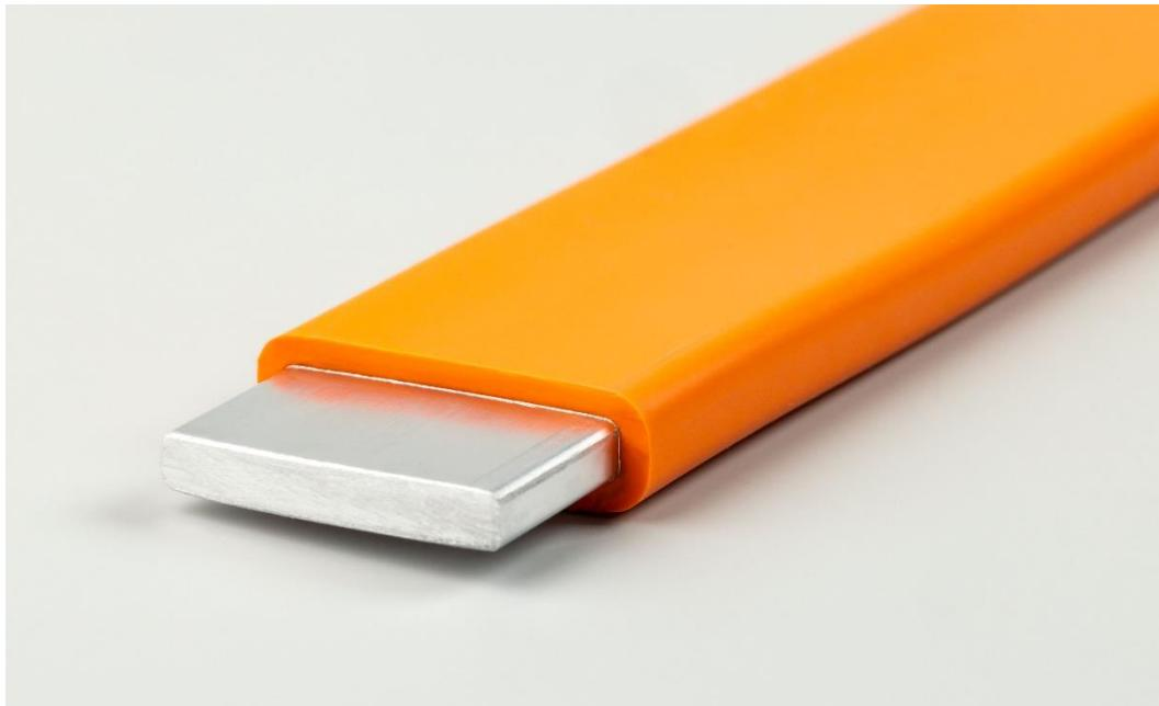
用 ELASTOSIL® R 531/60 绝缘的母线：这种新型硅橡胶能够在发生火灾时陶瓷化，即使在发生事故或车辆起火时，也能保障导电母线的绝缘性，为电动汽车乘客和救护人员提供额外的保护。（照片：瓦克）
