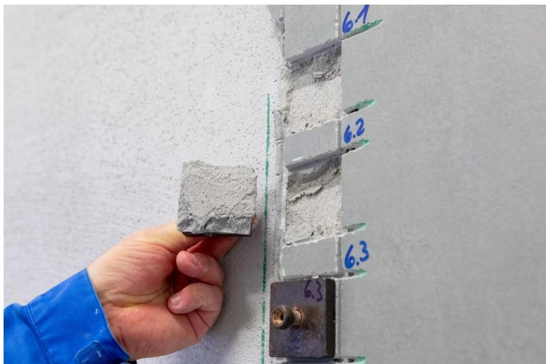
用含CEM II水泥，以及在三元共聚物中聚入憎水单体的VINNAPAS®威耐实® 8118 E、8620 E或7220配制瓷砖胶粘剂，可显著提高其浸水后的拉伸粘结强度，满足相应标准的要求。（照片：瓦克化学股份有限公司）
