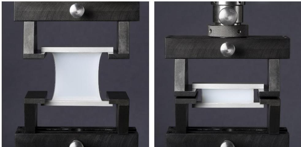
实验室测试表明，基于 GENIOSIL® STP-E 340 粘结剂的密封胶具有出色的回弹性能：瓦克在新一届欧洲涂料展（ECS）首次展示该产品。
