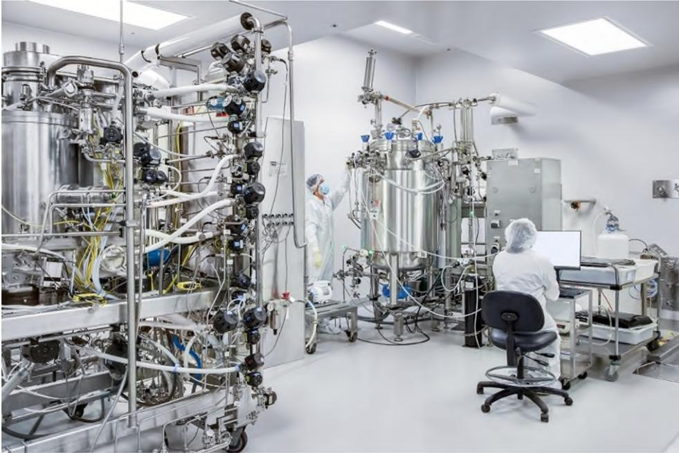
瓦克生物技术（美国）有限公司作为生物制药合同生产商（CDMO），拥有容量高达 650 升的微生物发酵生产线，可根据 cGMP（动态药品生产管理规范）生产和提纯 pDNA 及药用蛋白质。（照片：瓦克）
