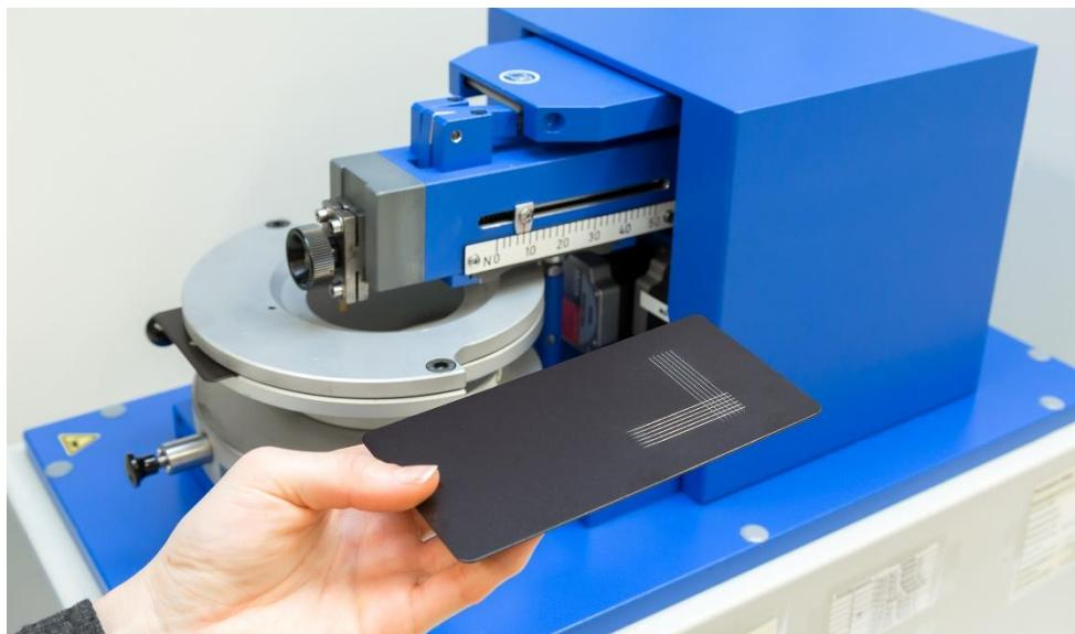
瓦克在 2023 年欧洲涂料展上展示一种供耐高温水基涂料配方使用的新型有机硅树脂：划格测试表明，用 **SILRES® M 51 E** 配制的涂料附着力良好，与用溶剂型硅树脂基料配制的耐热涂料不相上下。（照片：瓦克）
