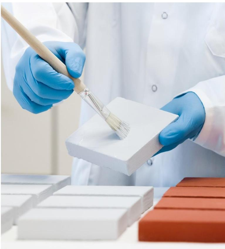
瓦克在 2023 欧洲涂料展上展示 SILRES® S 338 这种供硅酸盐内墙涂料及抹灰使用的新型有机硅助剂：经它改性的涂料具有憎水性和透气性，且易于加工。（照片：瓦克）
