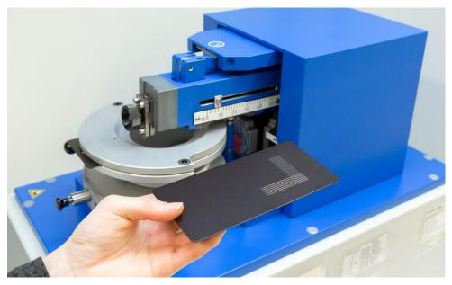
瓦克将在 ECS 2023 上展出一种用于耐高温水基涂料配方的新型有机硅树脂。划格测试表明,使用 SILRES® M 51 E 配制的涂料附着力好,与使用溶剂型硅树脂基料配制的耐热涂料不相上下。(照片: 瓦克)
