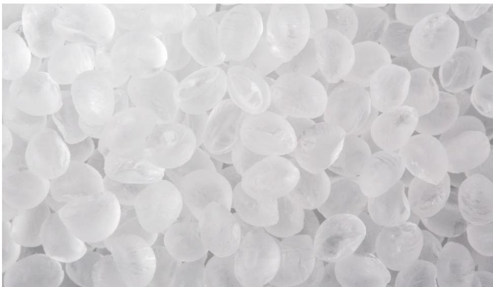
瓦克在 2022 年国际塑料及橡胶博览会（K 展）上展示供可生物降解聚酯改性使用的新型添加剂母料：这些粒状混合物由醋酸乙烯酯基聚合物树脂和聚乳酸组成，与纯粹基于醋酸乙烯酯的树脂相比，更易于加工。（照片：瓦克）
