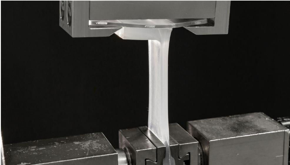
附着力测试证明，瓦克化学集团新开发的 **ELASTOSIL® LR 3078** 自粘型硅橡胶对聚碳酸酯具有出色的附着力。（照片：瓦克）
