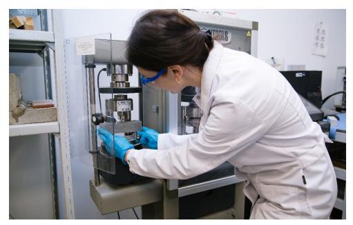
瓦克新设莫斯科水泥及混凝土憎水处理实验室提供的服务,也包括用以再现混凝土配方的强度机械压力测试。(图片: 瓦克)
