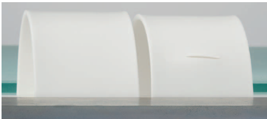
Bild 2. Labortest zum Non-healing-Effekt: Prüfplatte aus einem Standardsiliconkautschuk mit vollständig zugewachsenem Schlitz (links), Prüfplatte aus Silpuran 6610/40 mit offenem Schlitz (rechts)
