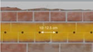
Anordnung der Bohrlöcher bei Druckinjektion mit SILRES® BS SMK 550
