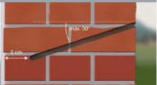
Anordnung der Bohrlöcher bei Druckinjektion mit SILRES® BS SMK 550
