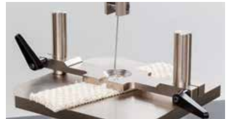
İlme bağlama testi ön kaplamanın ilk sırtlığın elyaflarına ne kadar iyi yapıldığını inceler.
