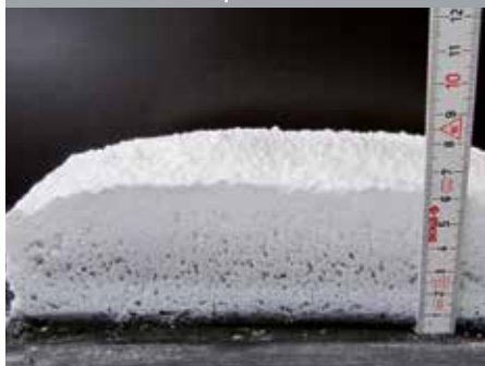
Измерение коэффициента расширения в испытании жаростойкости
