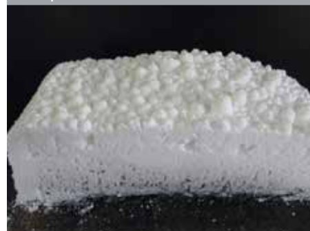
Пенообразование в испытании жаростойкости
