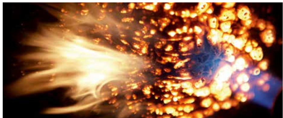
Test d'exposition au feu d'un revêtement intumescent à base de VINNAPAS® EZ 3112.
