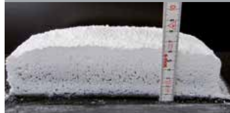
Mesure du facteur d'expansion après test d'exposition au feu
