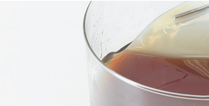
Anstieg der Quellung nach Lagerung in verschiedenen Getriebeölen bei 150 °C
