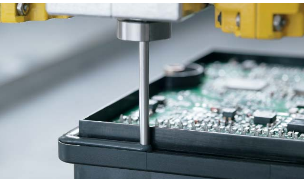
Automatisierte Verklebung von Gehäusebauteilen mit WACKER Siliconen – zuverlässig und rationell.
