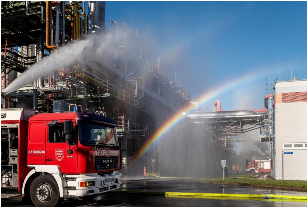
Niederschlagen und Auswaschen einer Gasemission mittels einem Wasser-Dachwerfer mit 4000 Liter pro Minute. Foto: WACKER
