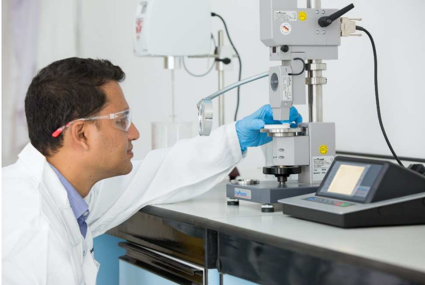
Das WACKER-Labor für Siliconelastomere in Dubai: Ein Mitarbeiter führt eine Shore-Härteprüfung durch. In der Region werden Siliconelastomere zunehmend in wachstumsstarken Branchen wie der Energiewirtschaft oder dem Formenbau eingesetzt (Bild: Wacker Chemie AG).
