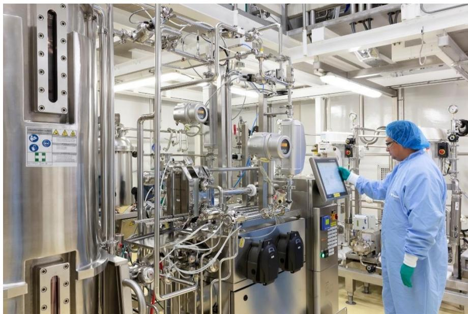
Blick in die Produktion von Wacker Biotech in Amsterdam: Neben Einweg-Bioreaktoren kommen bei der Produktion von lebenden mikrobiellen Produkten (LMPs) auch große Edelstahl-Fermenter mit einem Fassungsvermögen von bis zu 1500 Litern zum Einsatz (Foto: WACKER).
