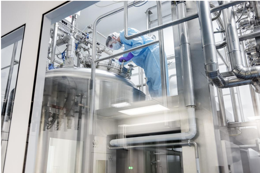
Zur Formulierung von mRNA-Wirkstoffen verwendete Lipide werden im mRNA-Kompetenzzentrum von WACKER in Halle in großen Stahltanks gelagert. Quelle: WACKER
