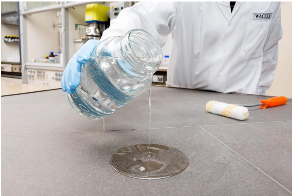
Mit silanterminierten Polymeren von WACKER lassen sich beispielsweise flüssige Abdichtungen herstellen. Solche Produkte sind hochelastisch und zugleich weiterreißfest. Untergründe sind damit vor Feuchtigkeit und Frostschäden geschützt. (Foto: WACKER)
