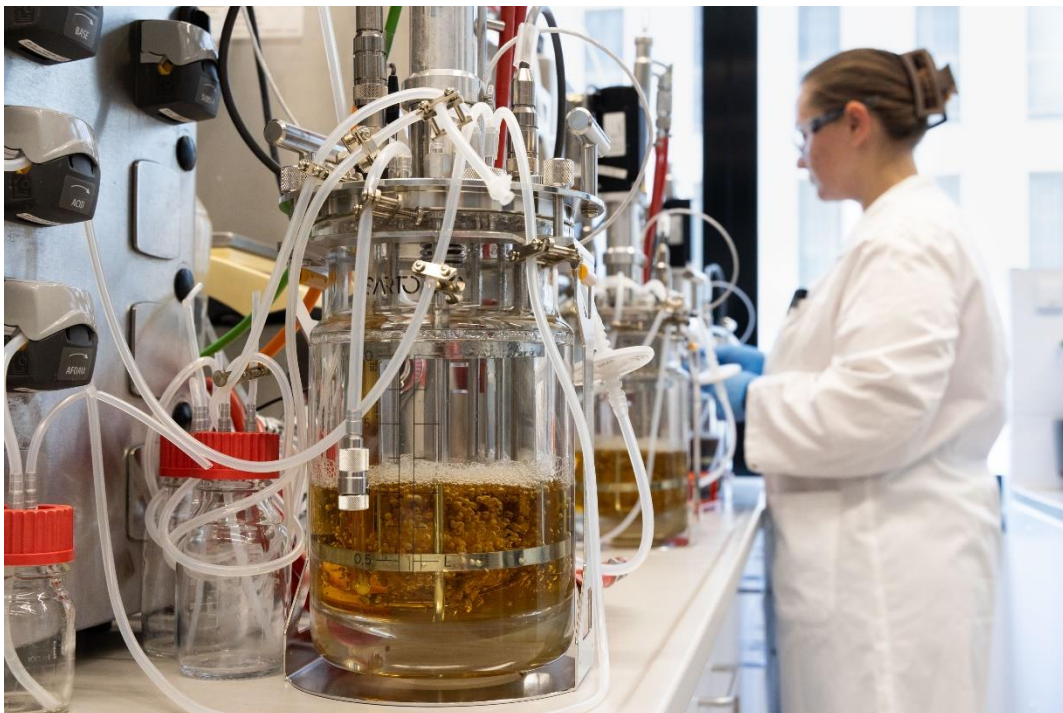
Bioreaktoren spielen bei der fermentativen Herstellung von Inhaltsstoffen für Nahrungs- und Nahrungsergänzungsmittel eine wichtige Rolle. Das WACKER Biotechnology Center setzt sie in Größen von wenigen Millilitern bis hin zum Pilotreaktor mit 200 Liter Fassungsvermögen ein. (Foto: WACKER)
