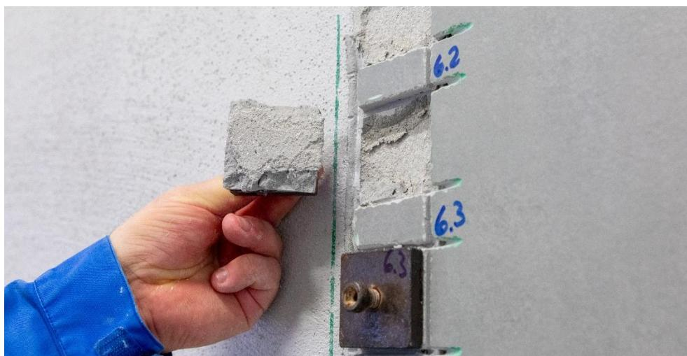
Bei der Formulierung von Fliesenklebern mit CEM II und VINNAPAS® 8118 E, 8620 E oder 7220 E, welche wasserabweisende Monomere im Terpolymer enthalten, verbessert sich die Haftzugfestigkeit nach Wasserlagerung deutlich, so dass die Normanforderungen erfüllt werden. (Foto: WACKER)
