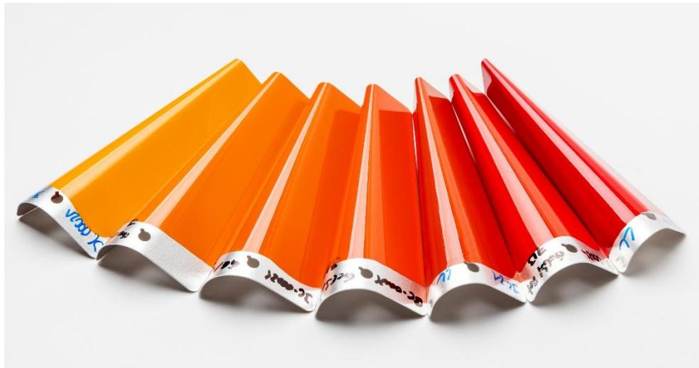
Metallbleche nach einem konischen Dornbiegetest. Der pigmentierte Epoxid-Polysiloxan-Decklack zeigt dank der hohen Flexibilität von SILRES® HP 2000 LV keine Risse. WACKER präsentierte den Härter erstmals auf der European Coatings Show. (Foto: WACKER)
