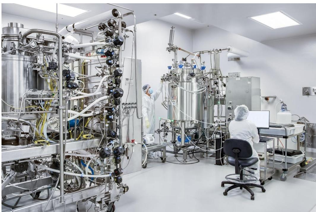
Als Auftragshersteller betreibt Wacker Biotech US Inc. mikrobielle Fermentationslinien mit einer Kapazität von bis zu 650 Litern zur cGMP-konformen Herstellung und Aufreinigung von pDNA sowie von Pharmaproteinen (Foto: WACKER).
