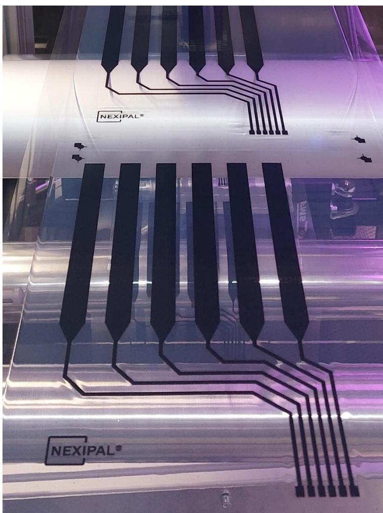
WACKER zeigt auf der Kunststoffmesse K 2025 elektroaktive Siliconlaminate der Marke NEXIPAL® Sense. Druck- oder Dehnbewegungen erzeugen unterschiedliche Spannungszustände, die präzise Sensorsignale für Anwendungen in der Medizintechnik, Robotik oder im Sportbereich liefern. (Foto: WACKER)
