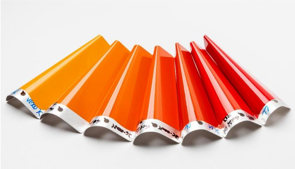
Metallbleche nach einem konischen Dornbiegetest. Der pigmentierte Epoxid-Polysiloxan-Decklack zeigt dank der hohen Flexibilität von SILRES® HP 2000 LV keine Risse. WACKER präsentiert den Härter erstmals auf der European Coatings Show. (Foto: WACKER)
