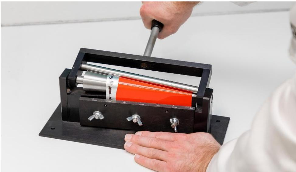
Prüfung der Flexibilität eines Epoxid-Polysiloxan-Decklackes mit dem Dornbiegetest. Der Lack basiert auf dem Härter SILRES® HP 2000 LV, den WACKER erstmals auf der ECS 2025 vorstellt. (Foto: WACKER)
