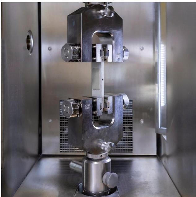
Rissüberbrückungstest nach EN 14981: Dichtungsschlämmen, die mit VINNAPAS® 754 ED und VINNAPAS® 764 ED formuliert wurden, können auch bei Temperaturen unter dem Gefrierpunkt noch Risse ausgleichen. Auf diese Weise ist das Bauwerk vor eindringendem Wasser zuverlässig geschützt. (Foto: WACKER)
