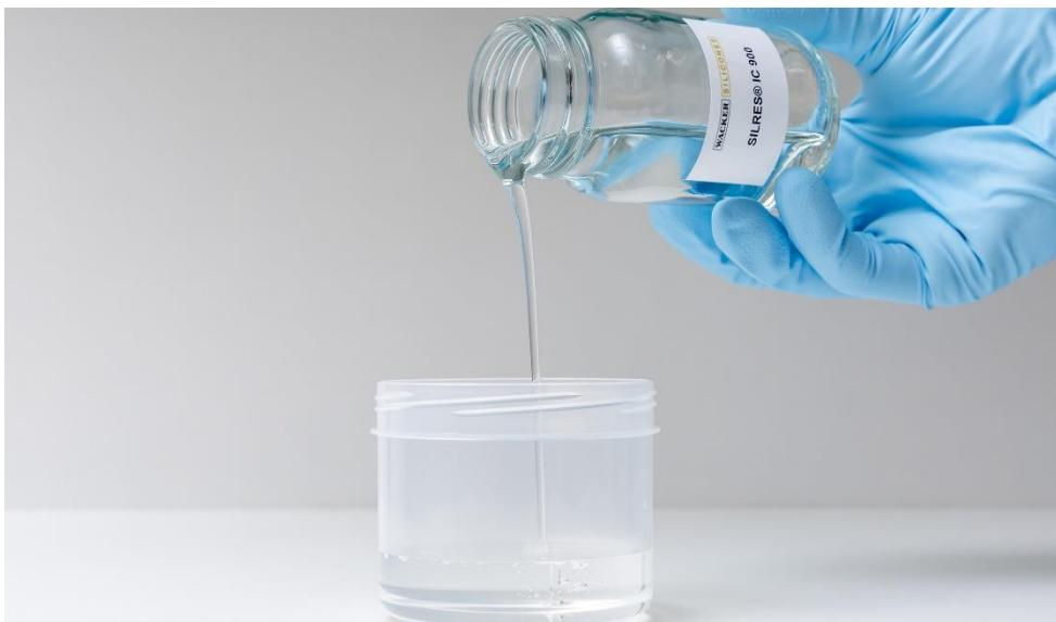
Feiert auf der ECS 2023 Premiere: SILRES® IC 900. Das Siliconharz wurde als Bindemittel für lösemittelhaltige Lacke entwickelt, die hohen Temperaturen trotzen müssen. Auch High-Solid-Lacke lassen sich mit dem Produkt formulieren. (Foto: WACKER)
