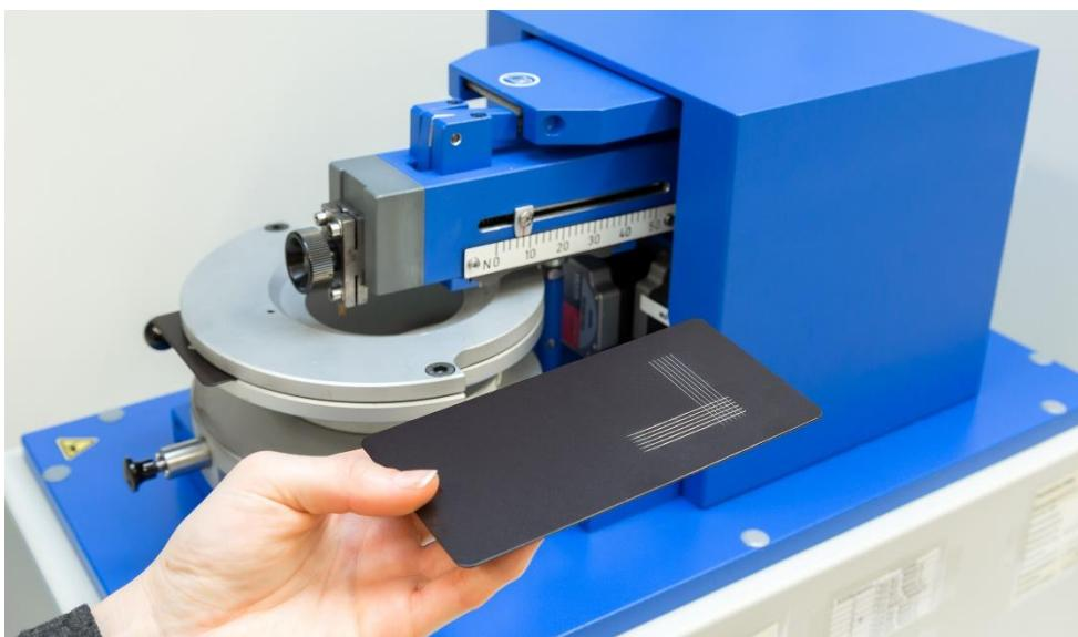
WACKER stellt auf der ECS 2023 ein neuartiges Siliconharz für hitzebeständige Lackformulierungen auf Wasserbasis vor. Gitterschnitt-Tests zeigen, dass SILRES® M 51 E ähnlich gut haftet wie mit lösemittelhaltigen Siliconharz-Bindemitteln formulierte Hochtemperaturlacke. (Foto: WACKER)
