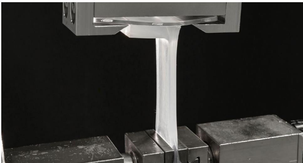
Auf der COMPAMED 2022 stellt WACKER ELASTOSIL® LR 3078 vor. Der selbsthaftende Flüssigsilikonkautschuk eignet sich zur Herstellung von Hart-Weich-Verbundbauteilen aus Polycarbonat. (Foto: WACKER)
