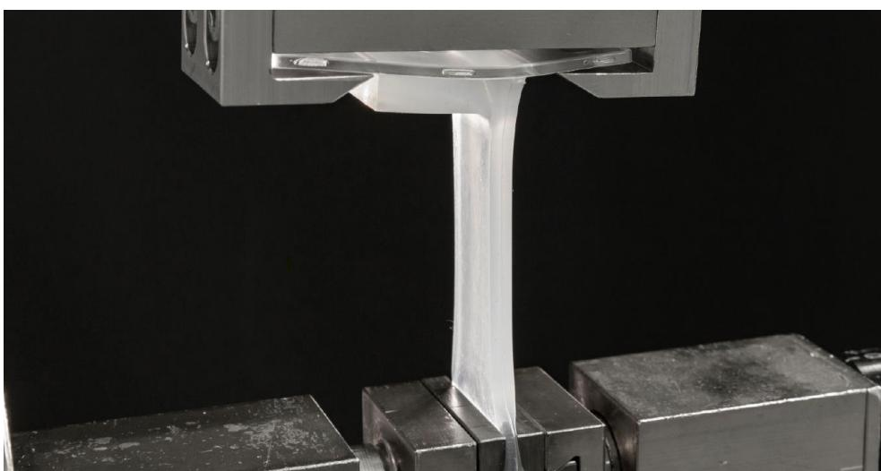
Tests zeigen, dass der neue selbsthaftende Siliconkautschuk ELASTOSIL® LR 3078 des Chemiekonzerns WACKER auf Polycarbonat ohne Vorbehandlung exzellent haftet. Das ermöglicht eine effiziente Großserienproduktion von Polycarbonat-Silicon-Verbundbauteilen, beispielsweise in der Medizintechnik. (Foto: WACKER)
